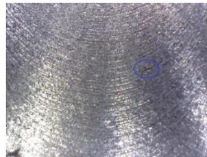
Para disminuir el grado de variabilidad de los resultados obtenidos se tomaron diez imágenes por ranura mecanizada, en donde se determinó la longitud de cada una de las grietas visualizadas por imagen, obteniendo el rango **intercuartílico (RIC)** y el promedio de longitud en **centímetros** por grupo mecanizado como se detalla en la [Tabla 9](#) [14].
