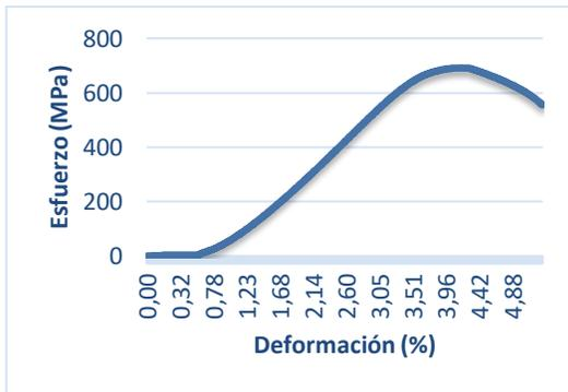
Gráfico 2. Curva esfuerzo deformación ensayo de compresión.
