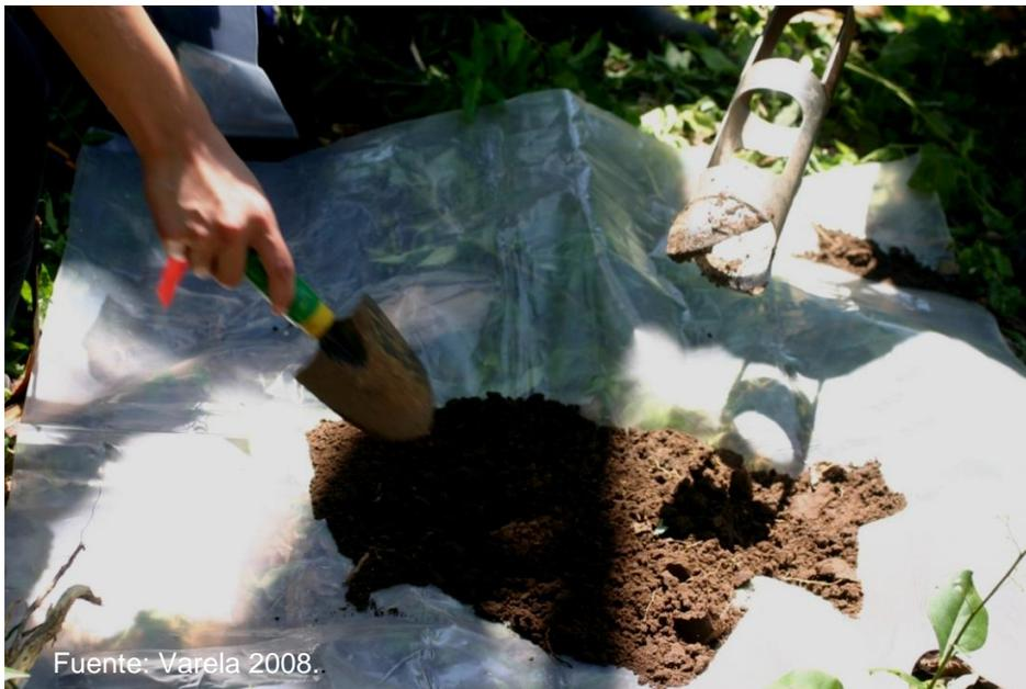
**Figura 2.** Mezcla de todas las submuestras tomadas de los cinco puntos de la parcela para conformar la muestra compuesta.
