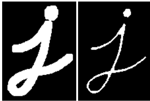
(a) Proceso de dilatación (b) Proceso de erosión
