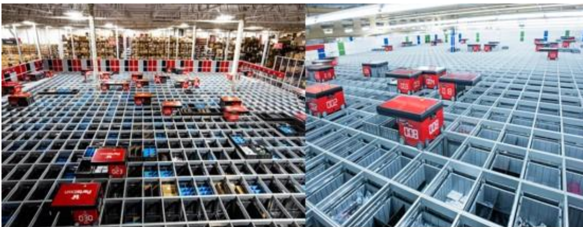
Figura 1: Sistema de control para AGVs en el marco de un ASRS. Fuente: Robotics & Automation News
