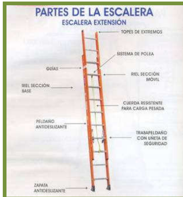
Figura 5. Partes de las escaleras (Escalera extensión)
