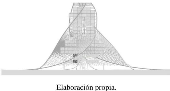
Por último, se explica la segunda fachada, la cual es una “cortina” que se posiciona sobre la estructura exterior de la máquina y busca a través de la localización de paneles de grafeno móviles, dar control de luz, aire, riego y recolección de datos de rendimientos,
