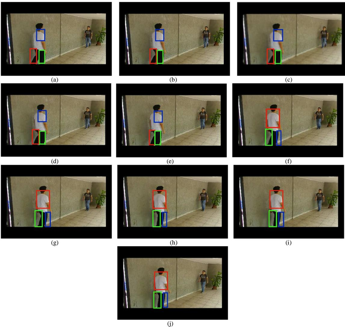
**Fig. 10.** Tracking realizado a las regiones de interés en una ventana de 10 frames para el video C19.avi: (a) Regiones de interés frame 56, (b) Regiones de interés frame 57, (c) Regiones de interés frame 58, (d) Regiones de interés frame 59, (e) Regiones de interés frame 60, (f) Regiones de interés frame 61, (g) Regiones de interés frame 62, (h) Regiones de interés frame 63, (i) Regiones de interés frame 64, (j) Regiones de interés frame 65.
