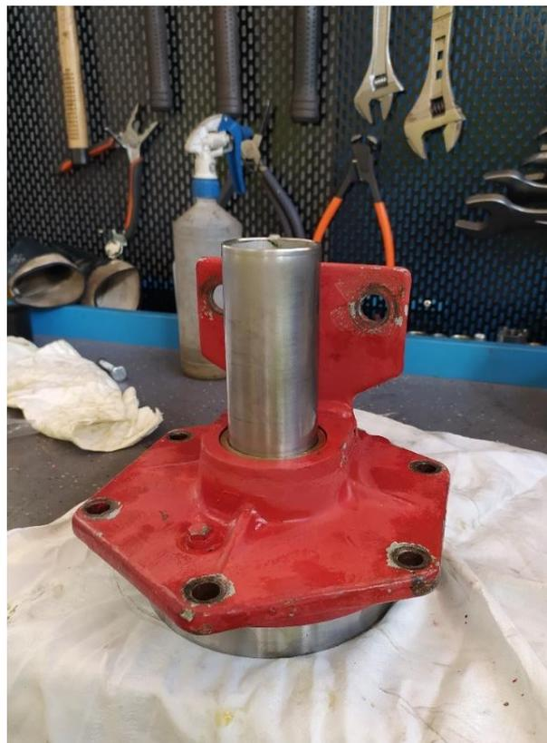
Ilustración 21. Pistón montado y fondo de cilindro limpios y ensamblados
