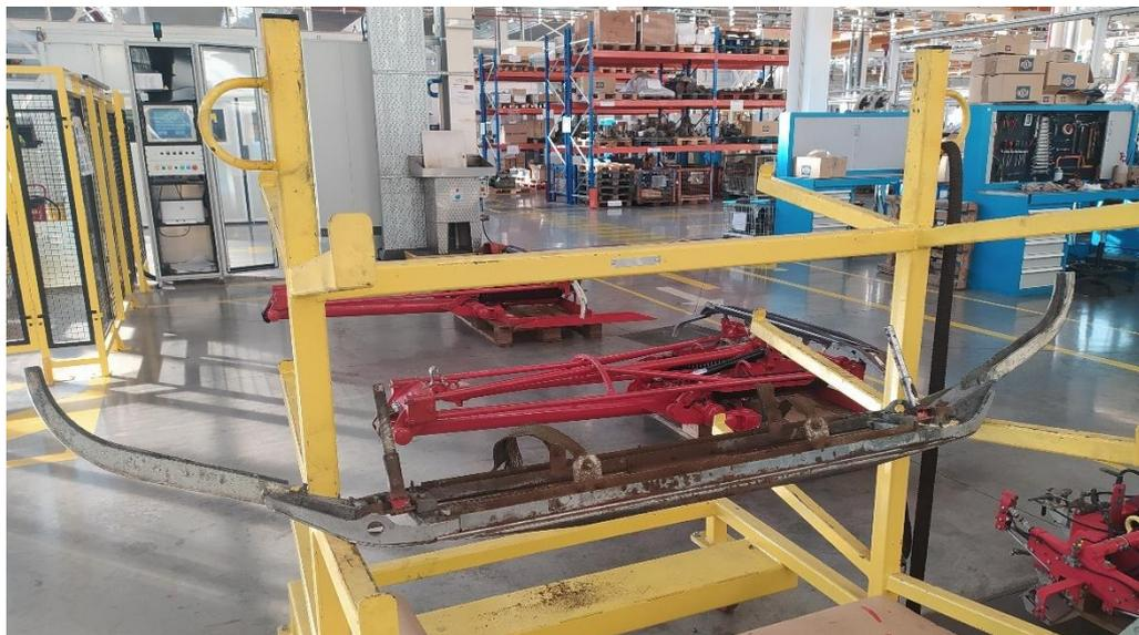
*Ilustración 13. Percha con un frotador desmontado*
