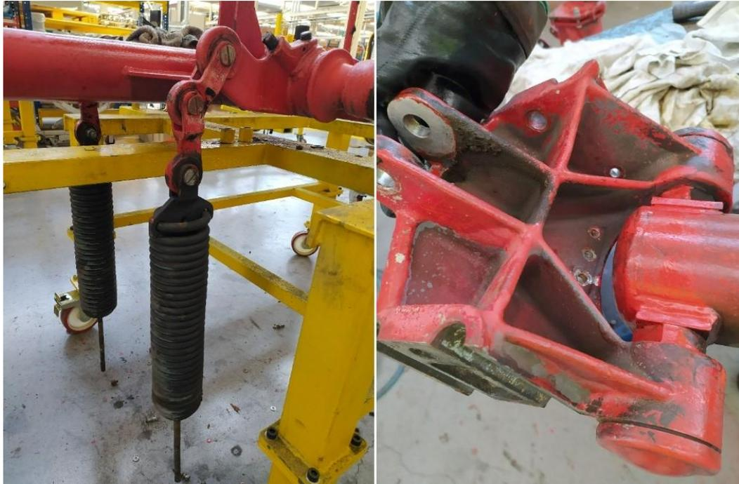
Ilustración 22. Rodamientos de los resortes (izquierda) y rodamientos y cojinete de la articulación superior (derecha)
