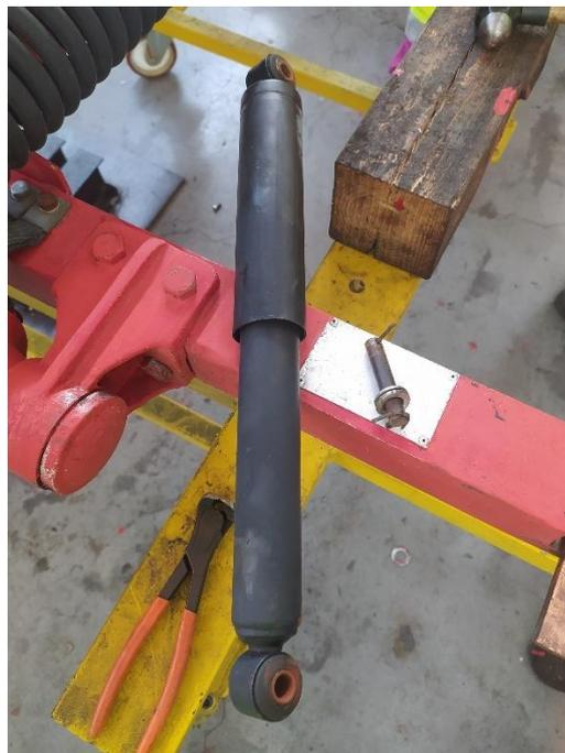
Ilustración 23. Amortiguador
