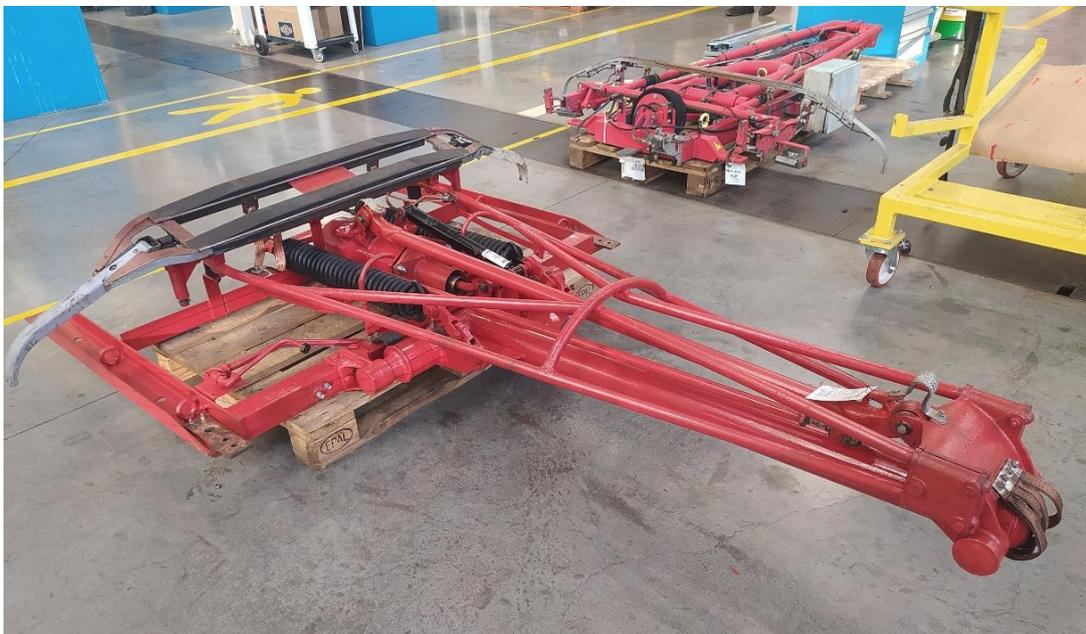
*Ilustración 6. Pantógrafo de la serie 447 después del proceso de mantenimiento*
