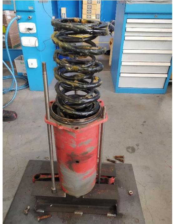
*Ilustración 20. Resortes de descenso antes de extraerlos del interior del cilindro*
