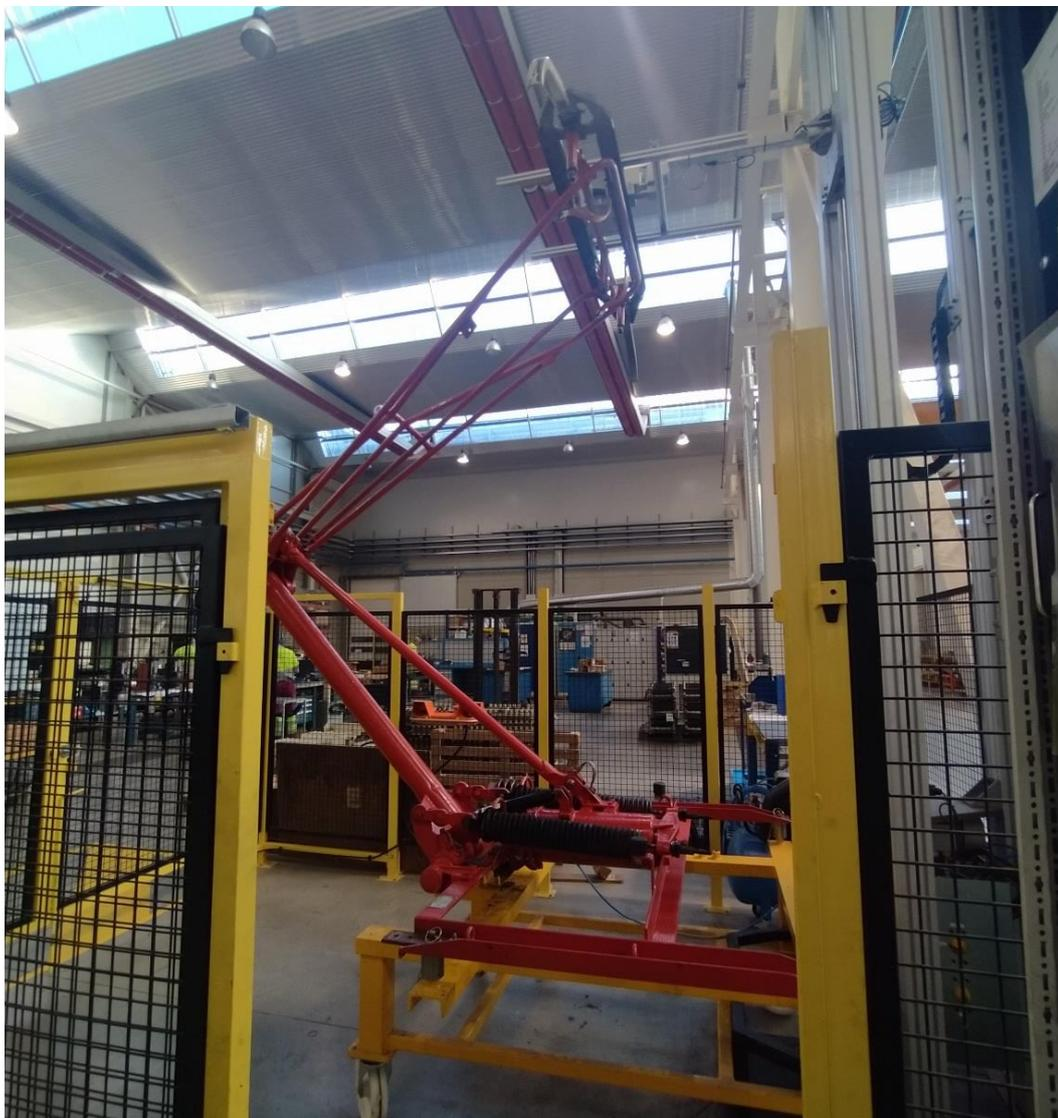
*Ilustración 24. Pantógrafo en el banco de pruebas*
