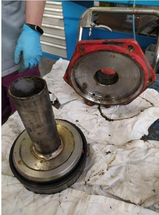
*Ilustración 19. Pistón montado (izquierda) y fondo de cilindro (derecha) antes de ser limpiados*
