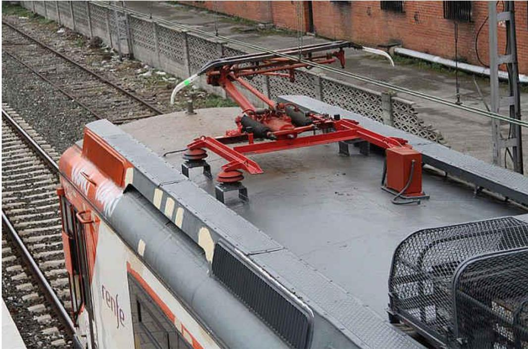
*Ilustración 5. Pantógrafo sobre el techo de un tren*
