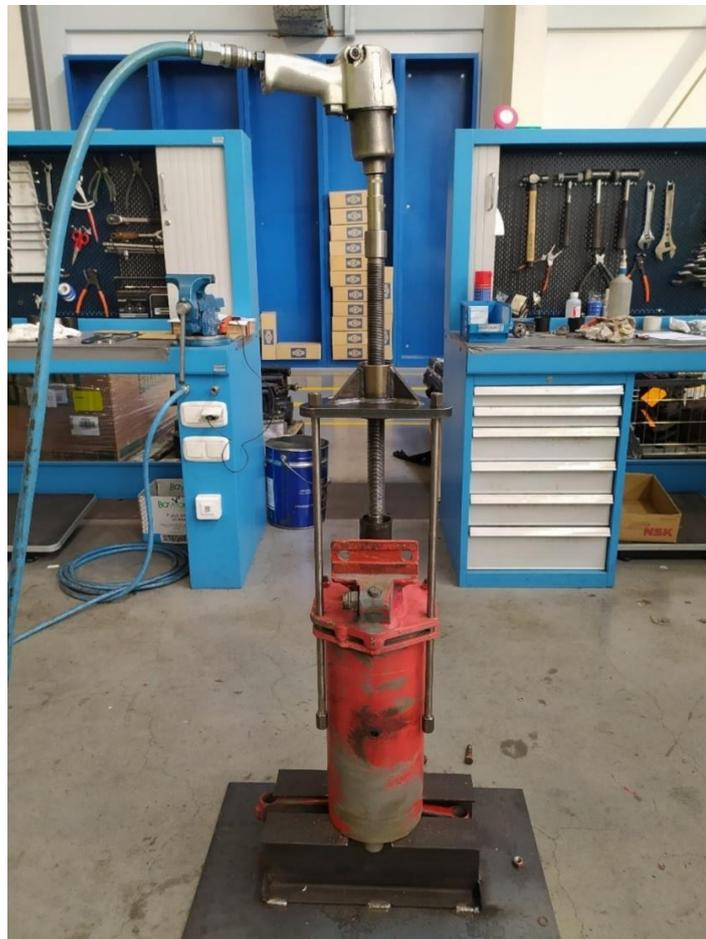
*Ilustración 18. Útil para desmontar el cilindro y motor de aire comprimido sobre base auxiliar (de arriba abajo)*
