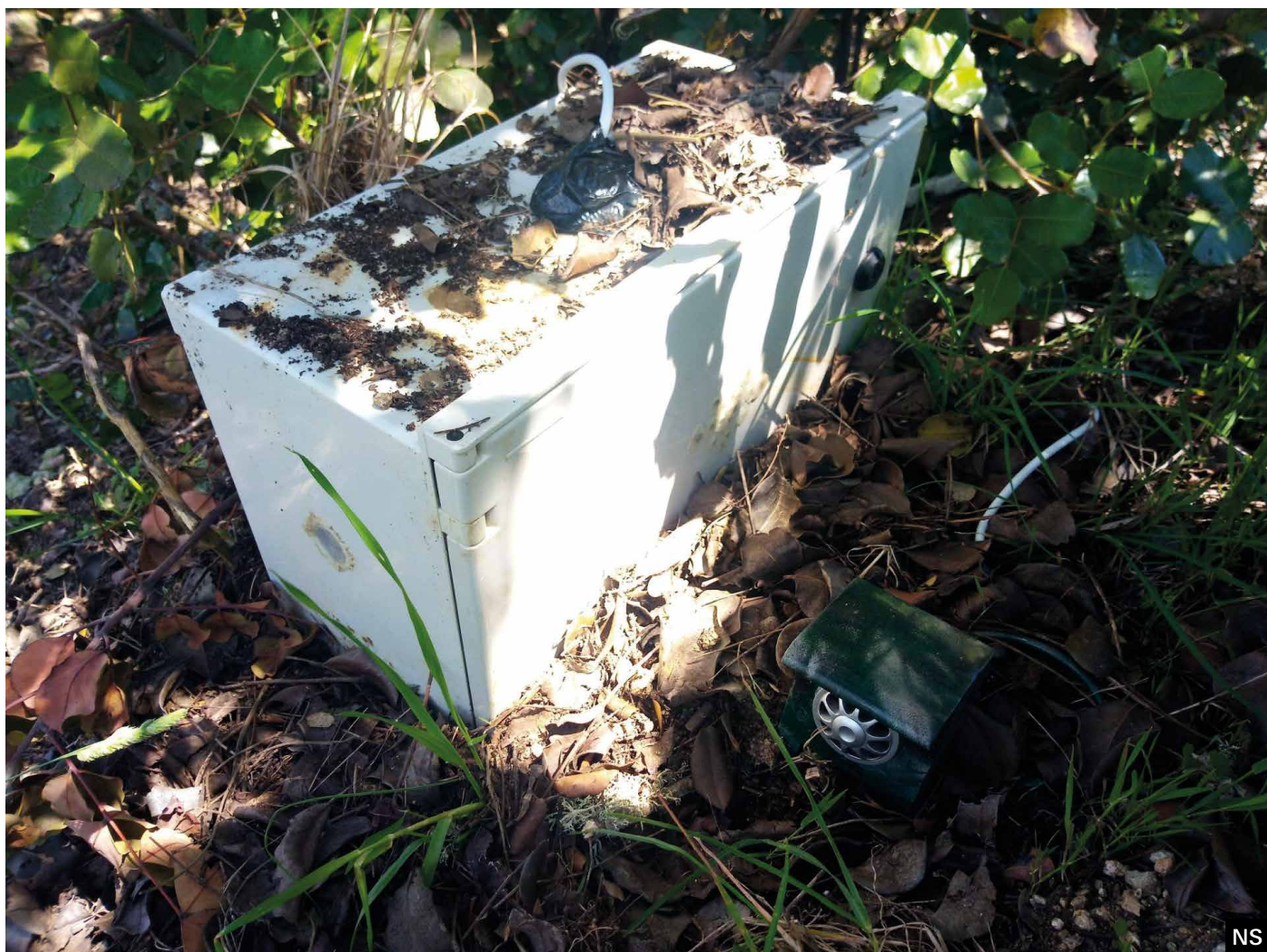
Colocação do protótipo dissuasor de micromamíferos na faixa marginal de estrada.
