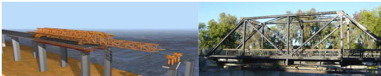
Figura 3 - (a) Treliça tridimensional - carrinho de avanço e (b) Treliça plana. Fonte: S.G. Maria, 2016
