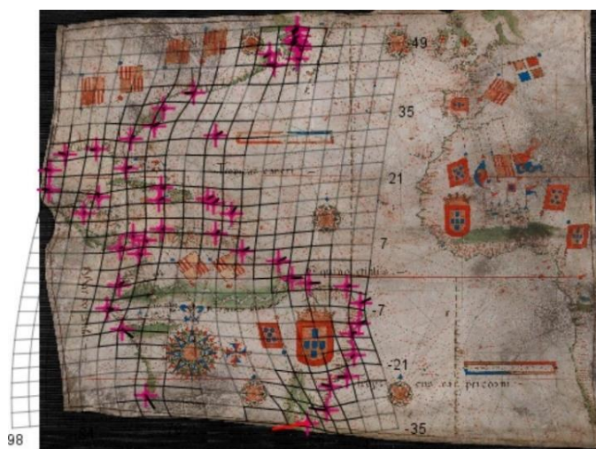
Figura 25 - Rede de distorção para a parte Ocidental
