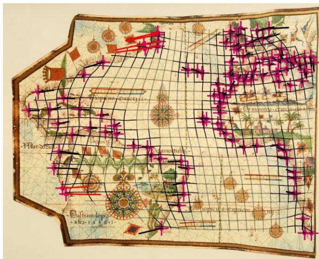
Figura 29 - Rede de distorção e vetores de deslocamento aplicados sobre a carta náutica (transformação afim de 6 parâmetros)
