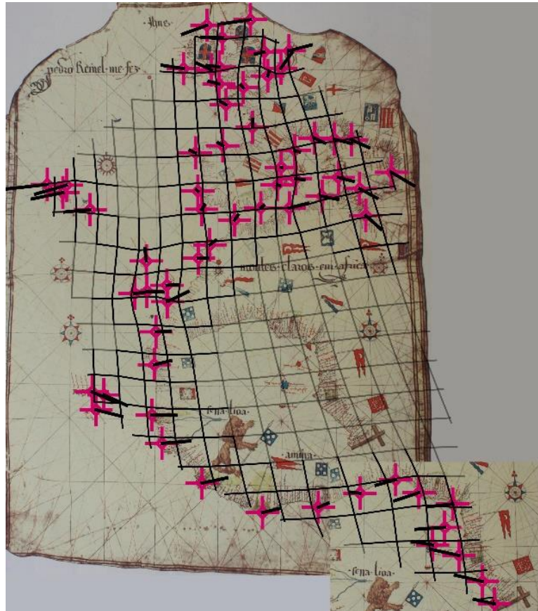
Figura 13 - Rede de distorção e vetores de deslocamento aplicados sobre a carta náutica (transformação afim de 6 parâmetros)
