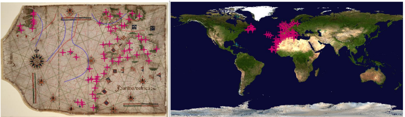
Figura 23 - Isolinhas de escala marcadas a vermelho e isolinhas de rotação marcadas a azul, com o mapa de referência utilizado à direita
