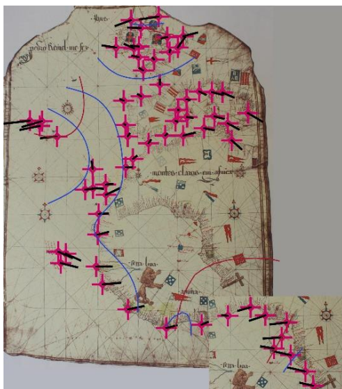
Figura 14 - Isolinhas de escala marcadas a vermelho e isolinhas de rotação marcadas a azul
