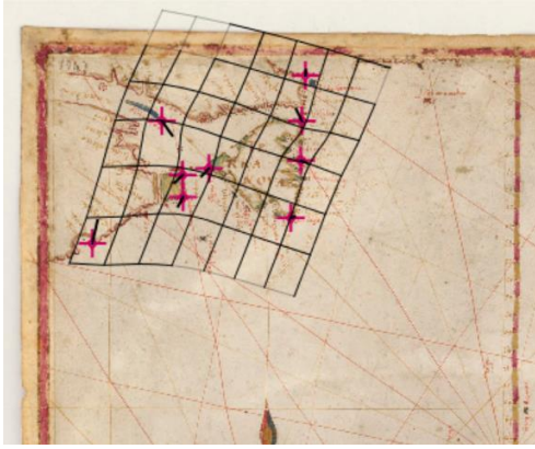
Figura 40 - Rede de distorção para a Terra Nova
