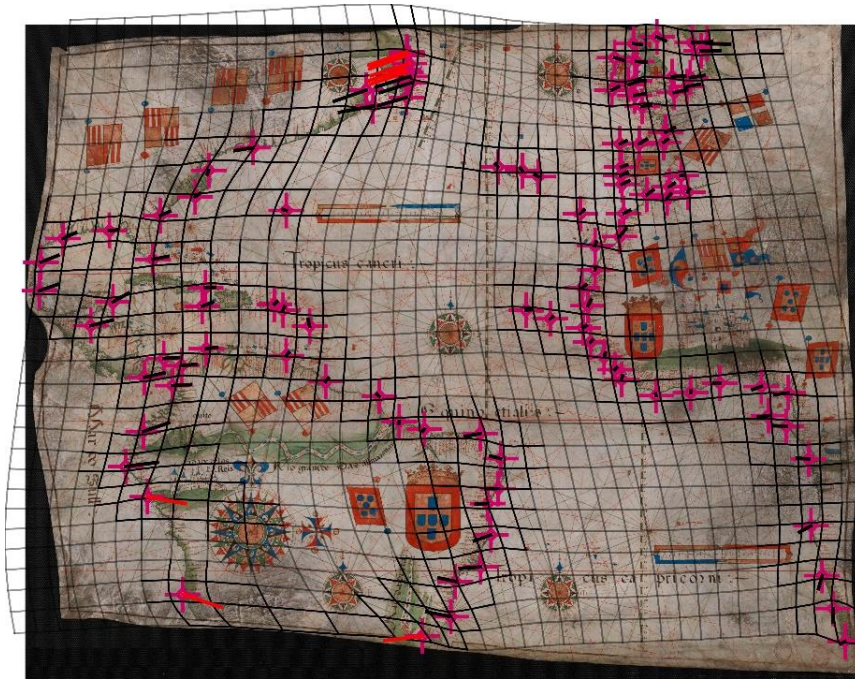
Figura 24 - Rede de distorção e vetores de deslocamento aplicados sobre a carta (transformação afim 6 parâmetros)
