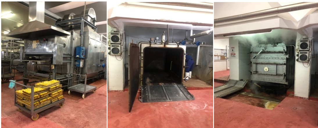
Figura 5 – Cozedor contínuo (a) e cozedor estático (b) e (c) de sardinha e cavala na CPN.
