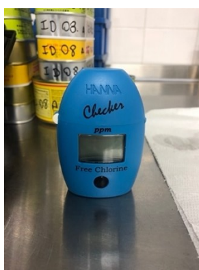
Figura 10 – Medidor de cloro livre utilizado na CPN (Hanna HI 96711, Itália)
