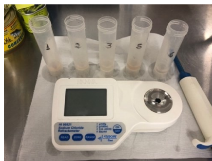
Figura 8 – Refratómetro digital portátil utilizado na CPN (Hanna HI 96821, Itália).
