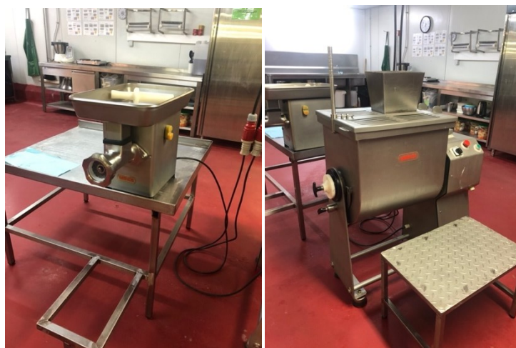
Figura 11 – Tritador de pescado (a) e misturadora de ingredientes (b) utilizados na linha de produção de patês da CPN.
