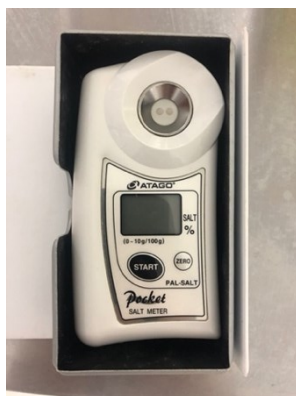
Figura 9 – Salinómetro digital utilizado na CPN (Atago, Tóquio, Japão).
