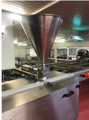
Figura 12 – Equipamento doseador utilizado na linha de produção de patês da CPN.
