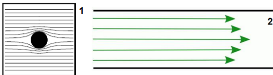
Figura 7: A primeira figura representa o movimento laminar por onde uma bolha está passando e a segunda figura as linhas pretas representam as paredes de um tubo e as linhas verdes representam o movimento laminar. Fonte: figura 1, https://edisciplinas.usp.br/mod/resource/view.php?id=1557654 , acessado em: 14 de janeiro de 2022, figura 2, https://www.gratispng.com/png-6lbsrf/ . Acessado em: 14 de janeiro de 2022.
