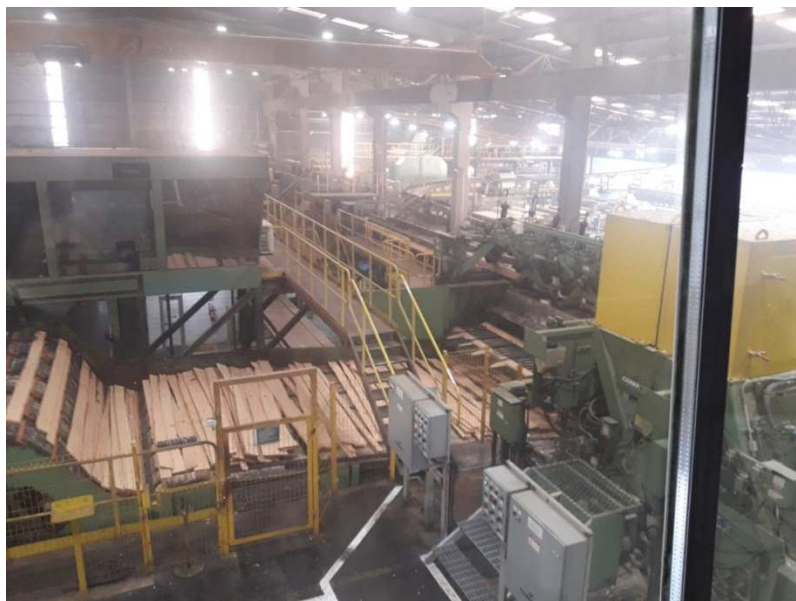
Figura 33: Redirecionamento de tábuas por esteiras
