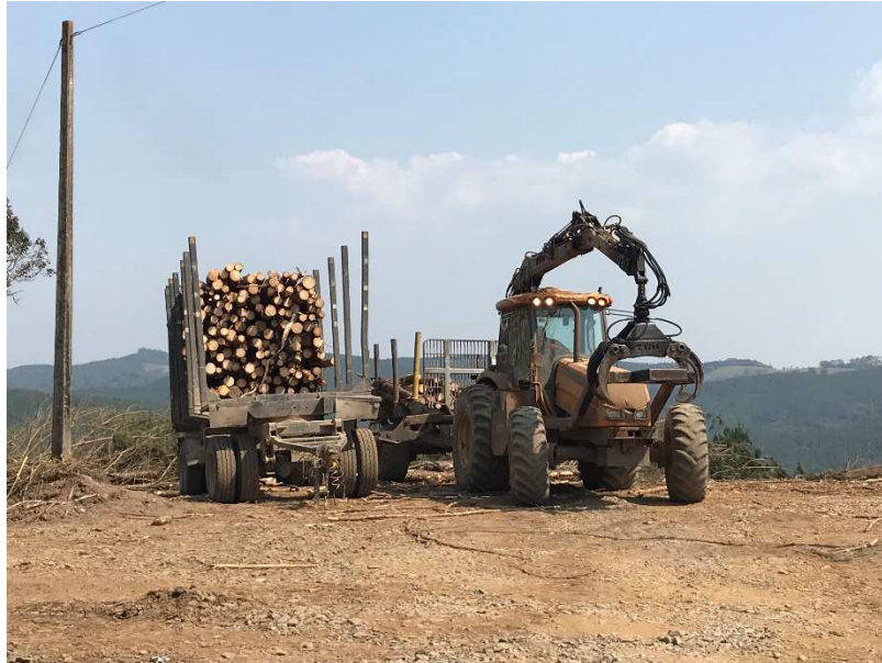
Figura 46: Carregamento de toras nos caminhões
