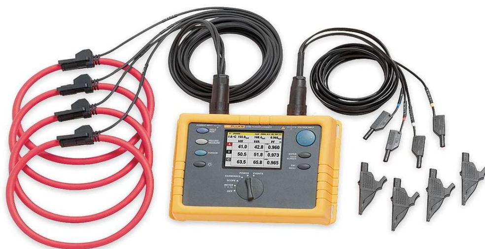
Figura 2.17: Equipo 1735 Power Logger - Fluke. Fuente: [38]
