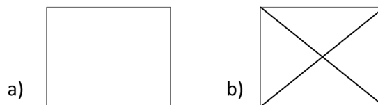
Figura 15. a) Pozo para MV, BV y AP, b) Pozo para Acometidas o Alumbrado.
