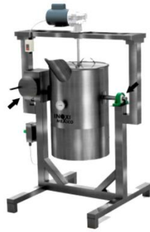
Figura 11. Sistema de volteo de una marmita. Fuente: INOXI MEXICO [55].
