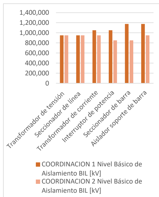
Figura 5. Comparativa de nivel básico de aislamiento BIL por equipos de subestación diseño 1 y 2 (1 y 2 descargadores, respectivamente).
