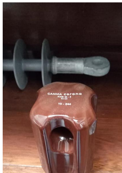
Figura 4. Polímero para retenida y aislador de tensor (COTO-EEASA-053-2020). Autor: Consorcio DG.
