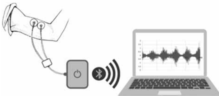
Figura 3. Ilustração do sistema Sensi.ax e aquisição de sinal EMG.
