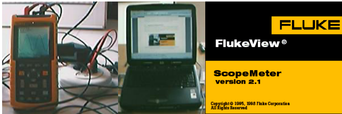
Figura 3-1: Imagens do ScopeMeter™ com as pontas de prova ligadas a uma tomada de alimentação doméstica, do computador portátil, e do frontal da aplicação FlukeView®.
