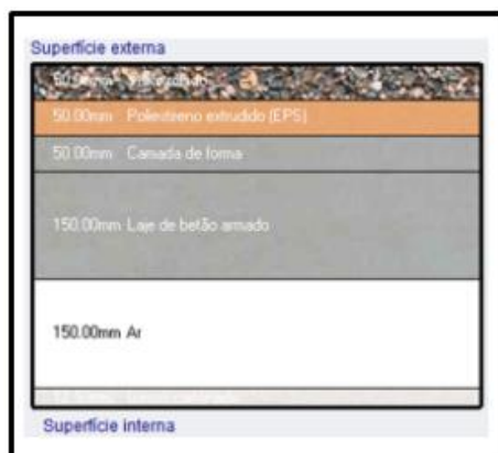
Figura 3-13: Pormenor construtivo da cobertura C1
