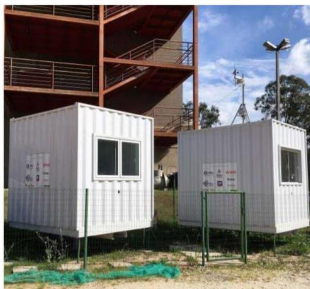
Figura 3-2: Câmaras bioclimáticas de baixo custo (ME à esquerda e MC à direita) [33]
