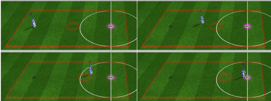
Figure 5.14: Exemplo do percurso do robô após treino na experiência 6 com obstáculo dinâmico
