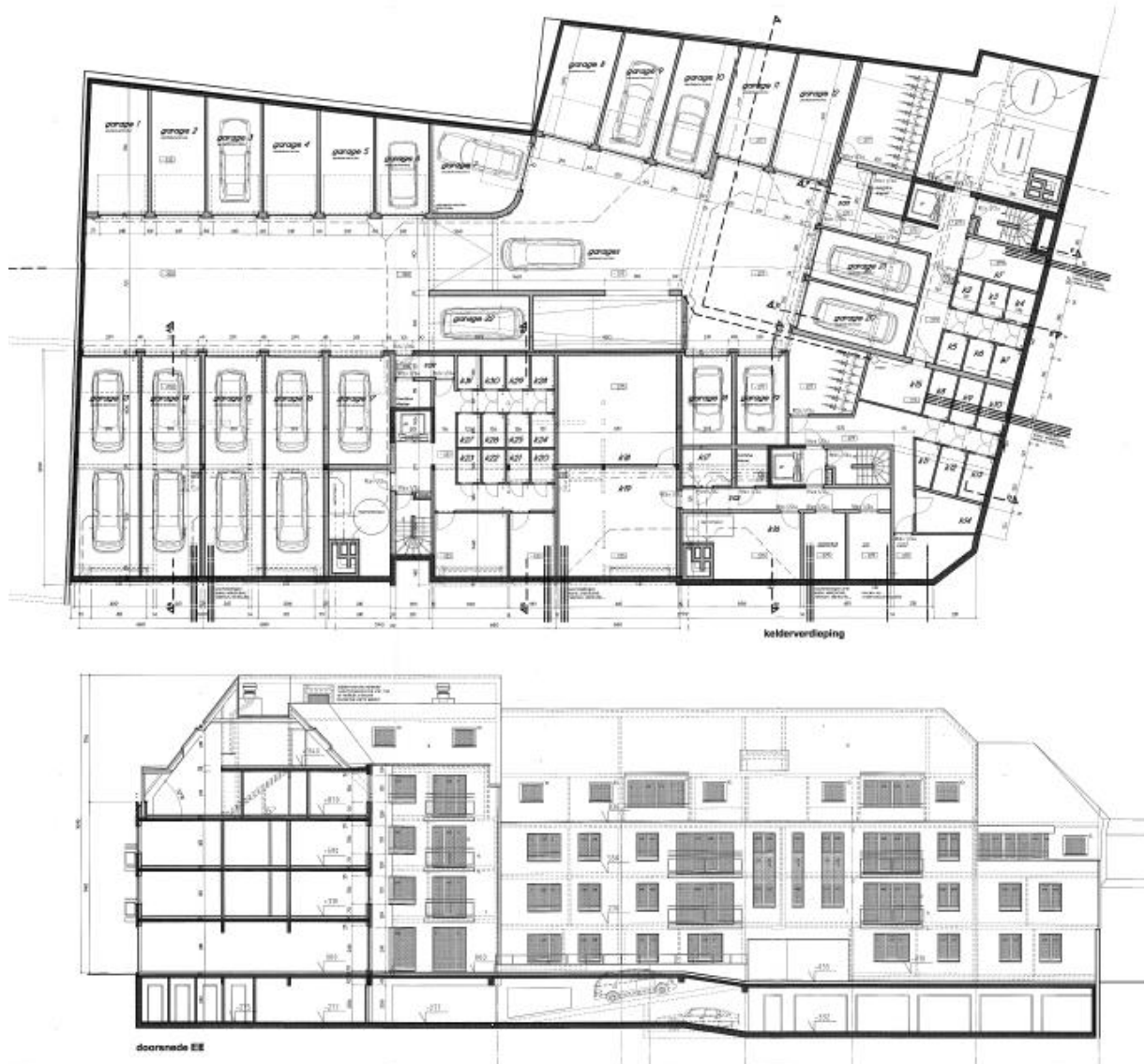
Figuur 26: Kelderverdieping + doorsnede EE (Bron: Stad Gistel).
