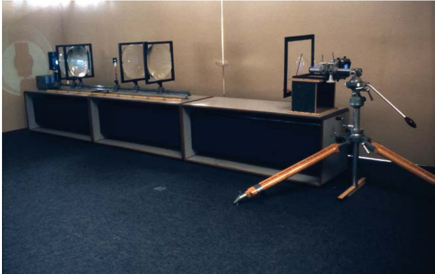
● Abb. 7: Optische Bank zur berührungsfreien Abtastung bzw. Aufzeichnung von Modellen. Quelle: ILEK Bildarchiv
