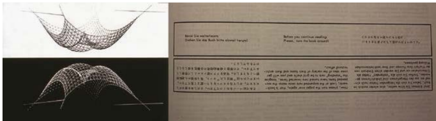
● Abb. 4: Negativ-Positiv-Druck eines fotografierten Hängemodells (li.) sowie dessen Umkehrung zur didaktischen Demonstration der Äquivalenz von zugbeanspruchter Hängeform und druckbeanspruchter Gitterschale (re.). Quelle: IL 10. Gitterschalen, Stuttgart 1974, S. 128; IL 10. Gitterschalen, Stuttgart 1974, S. 129, Fotos: Kirsten Wagner
