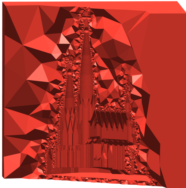
(d) Detail of the volume remeshing.
