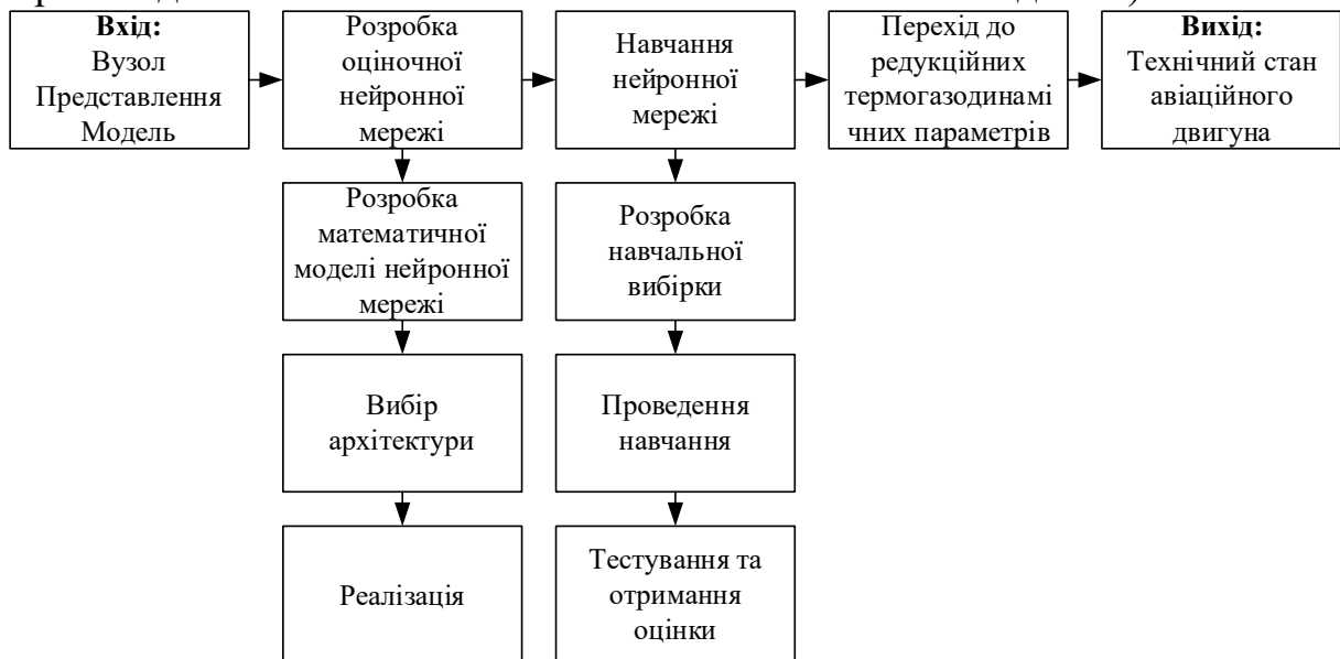
Рисунок 1 – Блок-схема інженерної методики контролю технічного стану авіаційних двигунів вертольотів у польотних режимах
