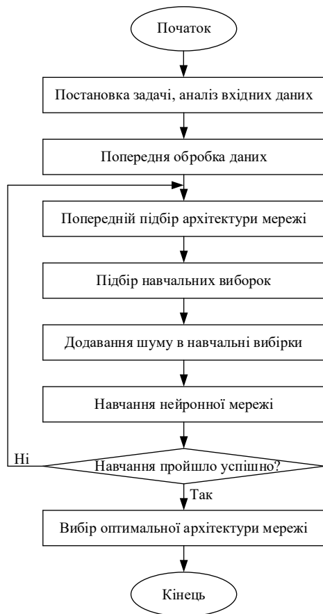
Рис. 2. Блок-схема алгоритму розв'язання задач апроксимації та класифікації із застосуванням ШНМ
