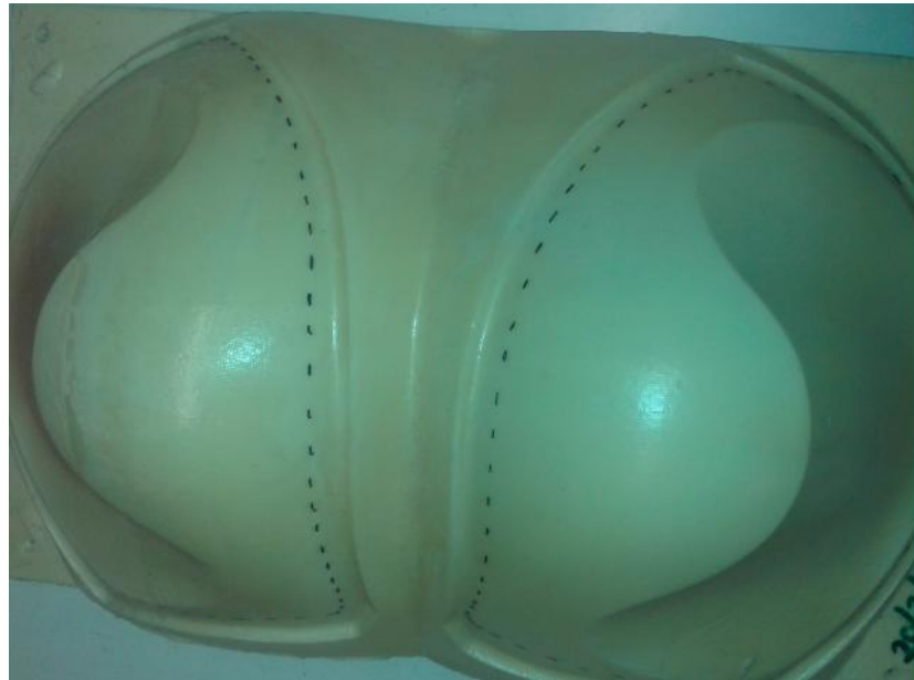
Ilustración 3.7-9. Molde pasa – no pasa para talla 105 modelo 1413
