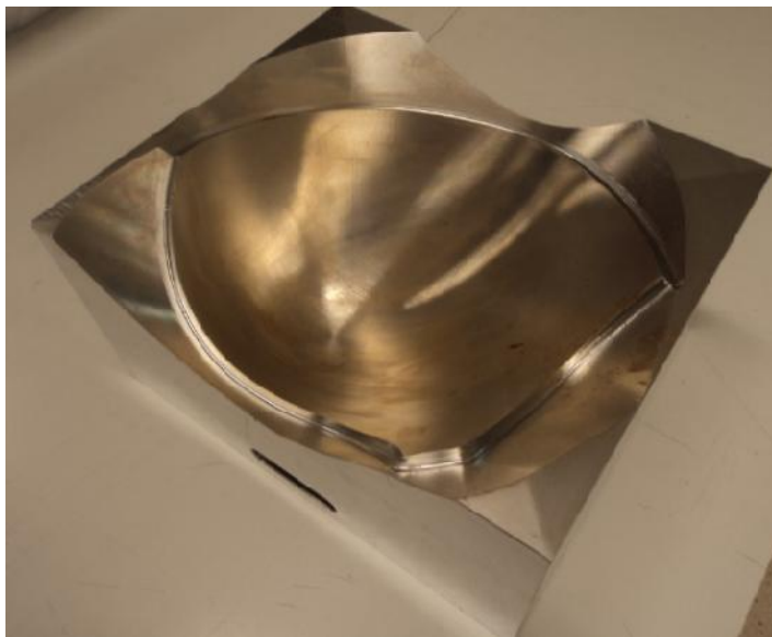
Ilustración 3.6.6-3. Molde hembra de aluminio de la talla 120
