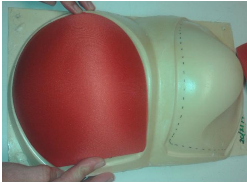
Ilustración 3.7-10. Verificación de las dimensiones de la copa en su poka-yoke
