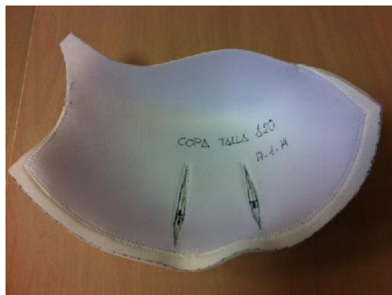
Ilustración 3.6. Copa patrón confeccionada manualmente correspondiente al modelo 1560 y talla 120.
