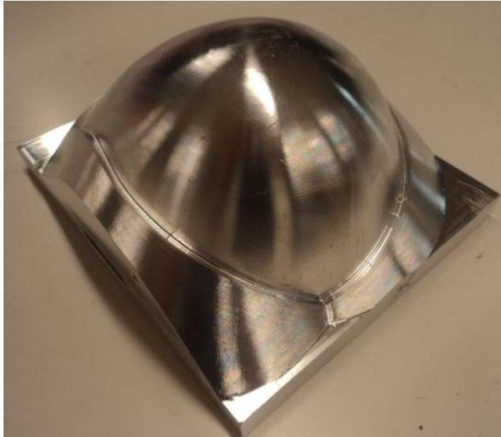
Ilustración 3.6.6-2. Molde macho aluminio de la talla 120
