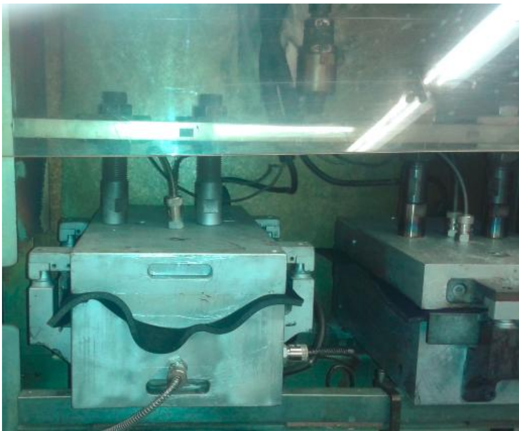
Ilustración 3.5.3-11. Plancha de foam en el molde de termoconformado
