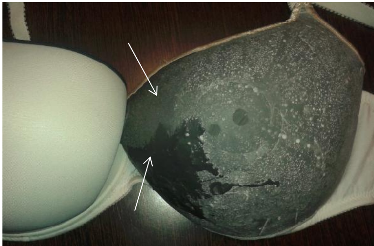
Ilustración 3.6.2-20. Copa en silicona obtenida en el molde de resina.
