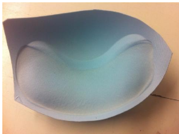
Ilustración 3.7-7. Pieza de prehormado de foam final para modelo 1413
