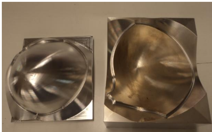
Ilustración 3.6.6-1. Molde de aluminio de la talla 120
