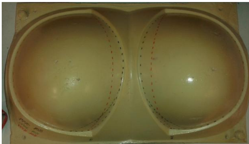
Ilustración 3.7-8 . Prototipo pasa – no pasa para talla 110 del modelo 1560
