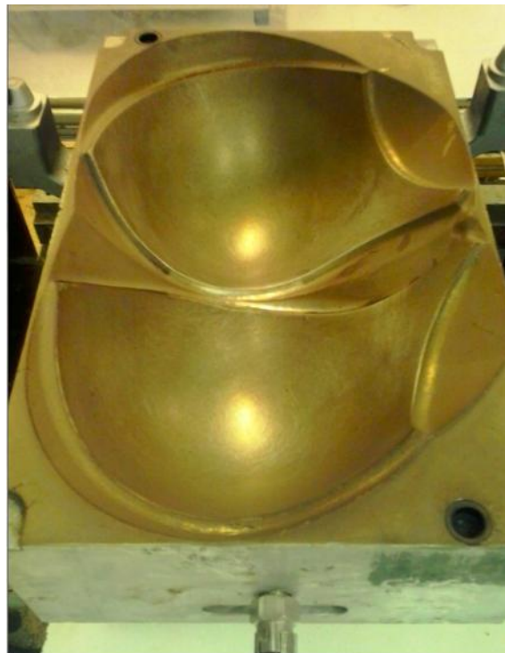
Ilustración 3.5.3. Molde de aluminio del modelo 1413 de la talla 105
