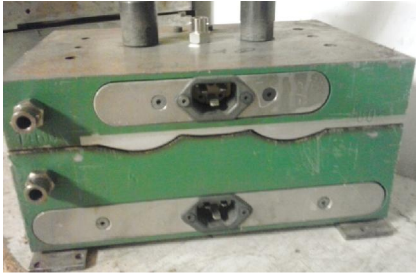
Ilustración 3.5.3-4. Imagen del molde de termoconformado con la disposición de las resistencias
