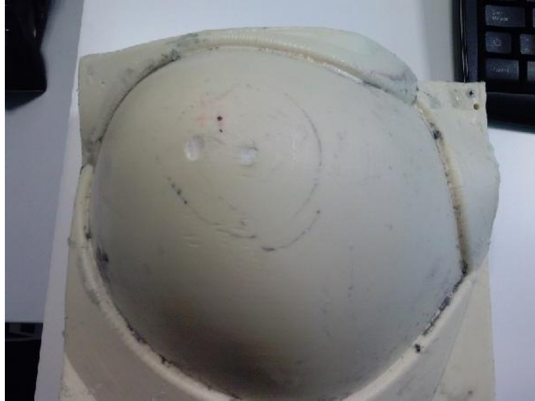
Ilustración 3.6.3-6. Molde de resina obtenido para realizar revisión 2
