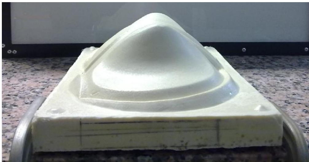
Ilustración 3.5.1-2. Molde macho prototipo de resina
