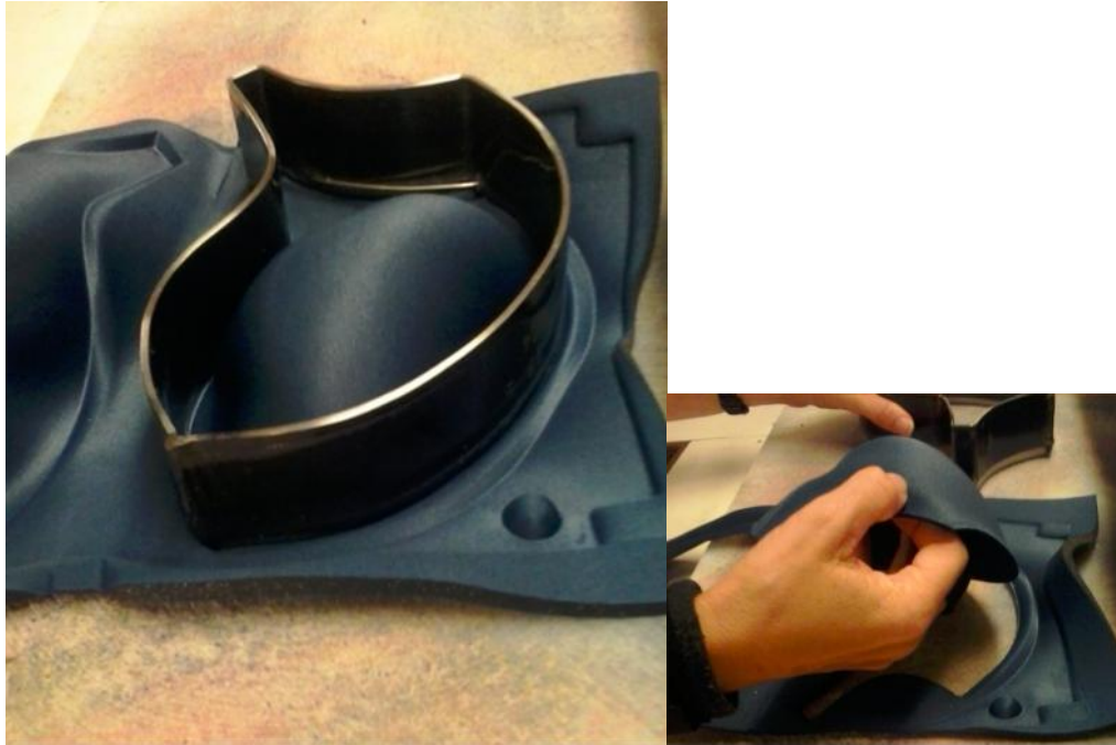
Ilustración 3.0-6-6. Etapa de troquelado del prehormado de foam
