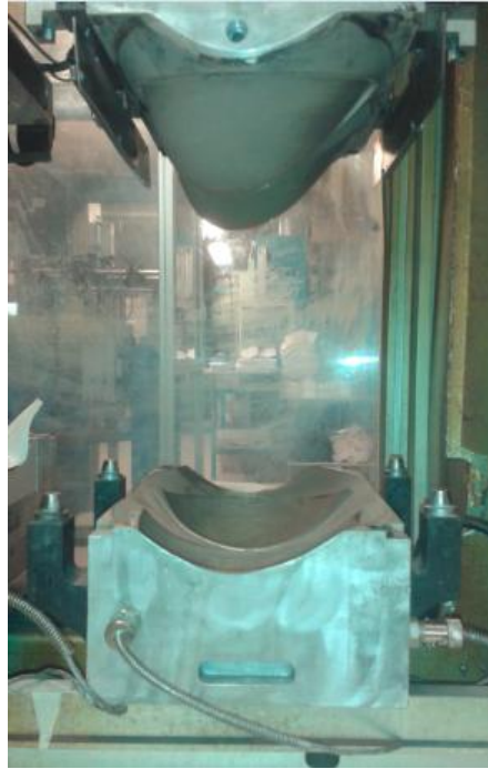
Ilustración 3.5.3-9. Molde termoconformado para prehormados simple
