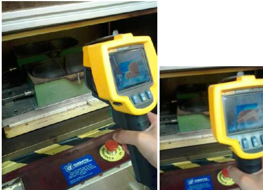
Ilustración 0-3.5.4-1. Cámara termográfica realizando termografía
