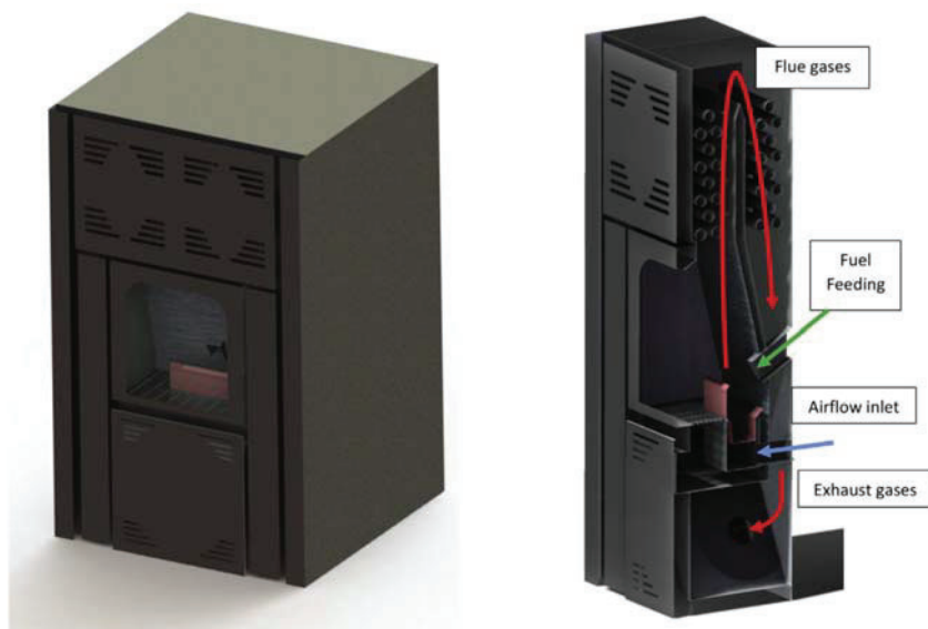
Figura 37. Diseño CAD tridimensional y esquema de la estufa [182].
