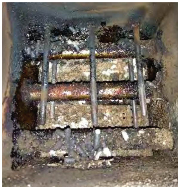
Figura 26. Materia no deseada adherida al sistema de refrigeración del lecho [151].
