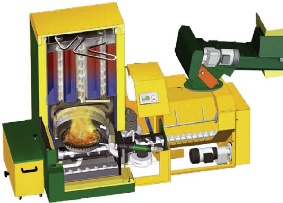
Figura 35. Esquema interno de la caldera KWB Multifire™ 60.
