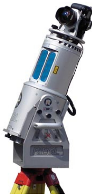
Abbildung 4.8: RiegI LMS-Z390 (RIEGL, 2007)
