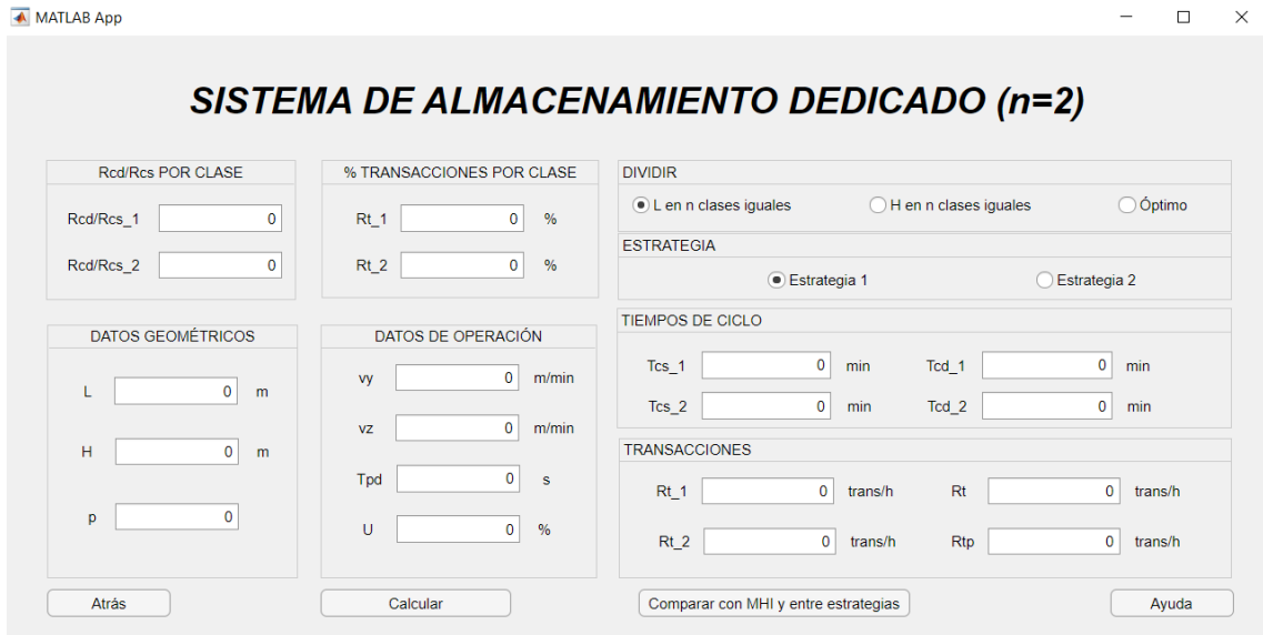
Figura 3.35 Ventana de cálculo para n = 2 con datos de entrada de porcentajes de transacciones por clase de AS/RS de Storage Calculator .
