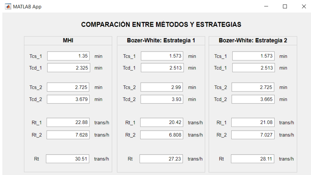
Figura 4.13 Comparación entre las soluciones del problema de almacenamiento dedicado en configuración vertical con porcentajes de tiempo de utilización como datos de entrada con MHI y Bozer-White de AS/RS de Storage Calculator .
