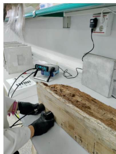
Fig. 1.89_Toma de medidas indirectas en bulbo
