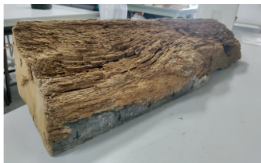
Fig. 1.85_Estado de la pieza a ensayar. Cara oculta vs visible
