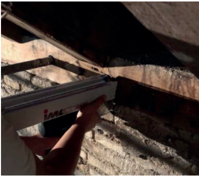
Fig. 1.75_Equipo ensayando un estribo en C5-AM [1]
