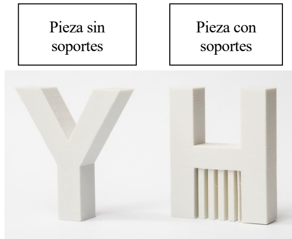
Figura 114. Soportes en la impresión [66]
