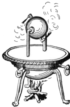
Figura 16. Aelopilo. El vapor de la caldera ascendía y salía por los tubos haciendo girar la esfera. [32]
