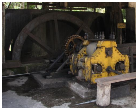
Figura 14. Trapiche hidráulico, accionado por el curso de un río [26]
