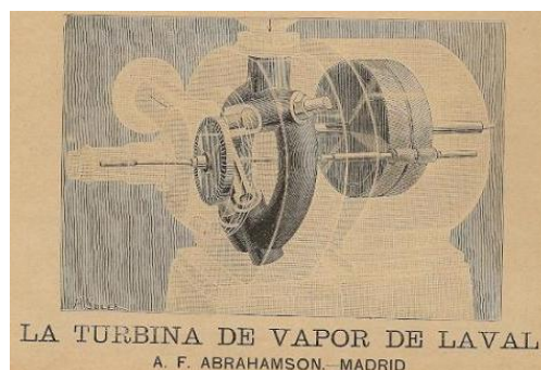
Figura 22. La turbina de vapor de Carl Gustaf Patrick de Laval [39]
