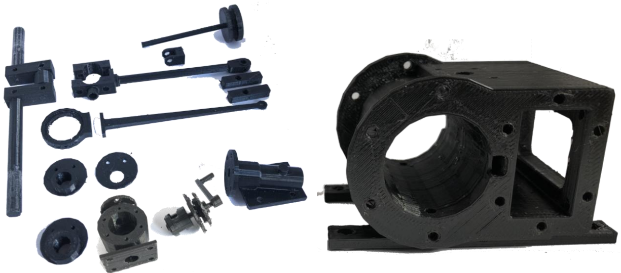
Figura 110. Modelos impresos de las piezas del motor de vapor
