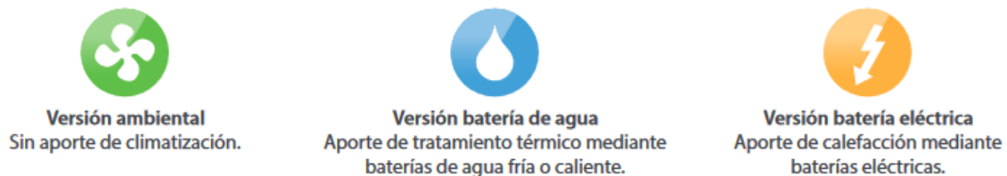
Ilustración 13: Pretratamiento del aire de entrada
