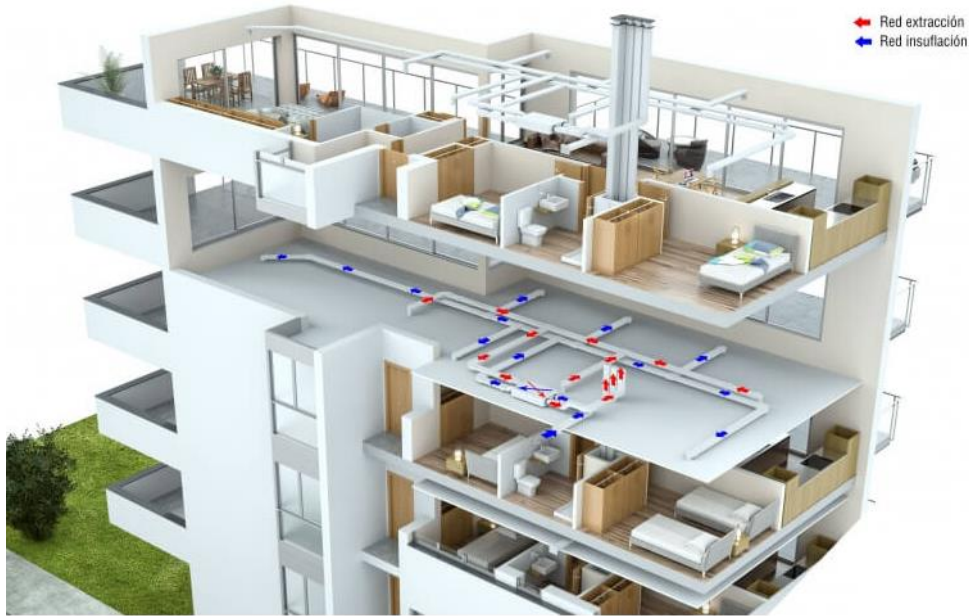
Ilustración 8: Sistema VMC Doble Flujo Plurifamiliar Individualizado (Siber)
