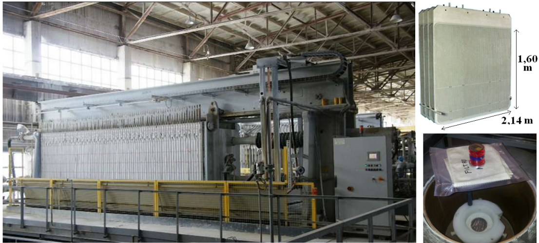
Imagen 7.1 Fotografía de filtros Moore en una industria y sus medidas geométricas. En la esquina inferior derecha, fotografía del proceso de transmisión con fuentes puntuales.
