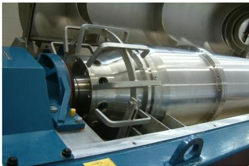
Figura 3-7. Centrifugadora horizontal.
