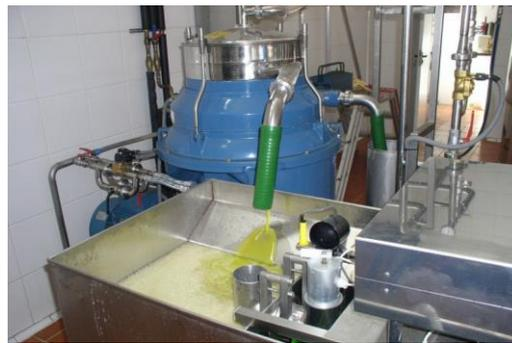
Figura 3-8. Centrifugadora vertical.
