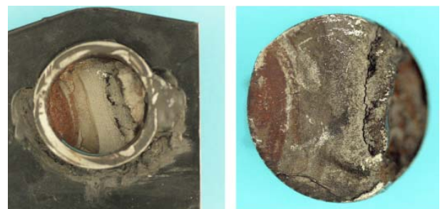
Figura 5. Aspecto de la superficie de rotura.
