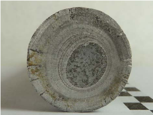
Figura 8. Aspecto de la rotura.
