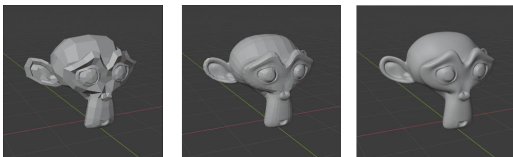
Figura 4-12. De izquierda a derecha: modelo original; subdivision surface aplicado una vez; subdivision surface aplicado tres veces.
