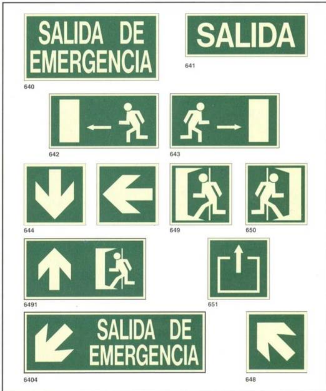
Ilustración 56. Señales de Salvamento y Vías de evacuación 2.
