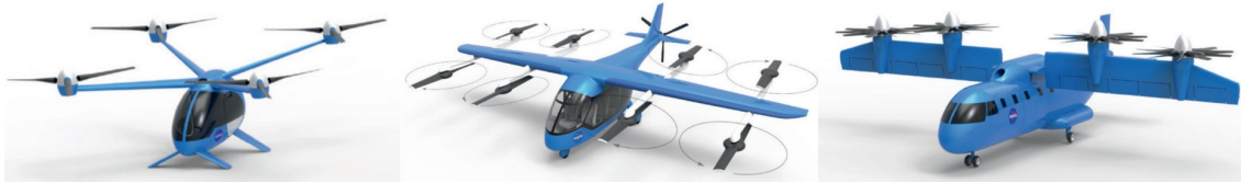
Figura 3.2 a) Multirrotor, b) Ascensión y crucero, c) Rotor basculante [17].
