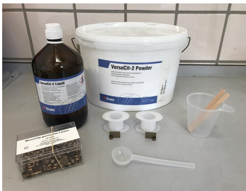
Figura A-3. Material para el empastillado de muestras
