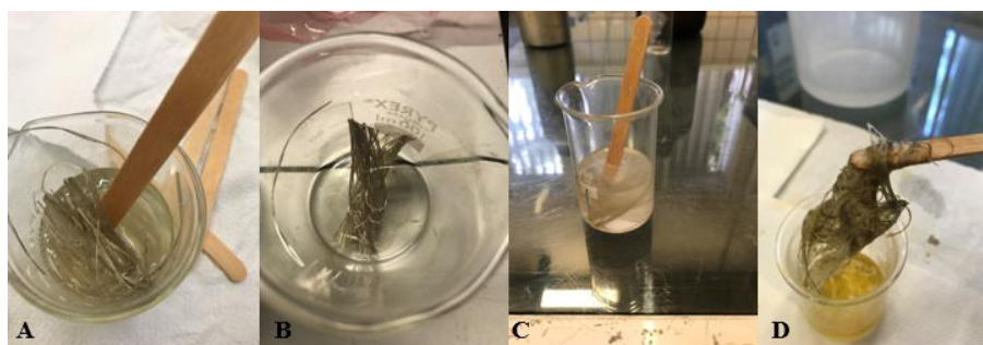
Figura A-9. Fibra con restos de epoxy (A isopropanol, B butanona, C diclorometano, D ácido nítrico)
