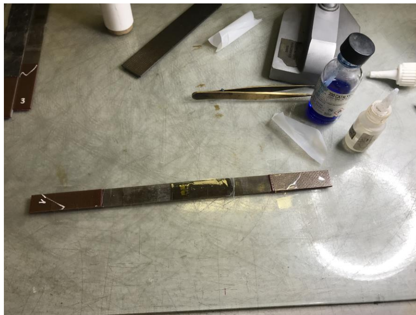
Figura 6-26. Pegado de bandas con el adhesivo Z70
