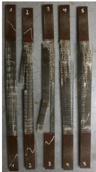
Figura 7-7. Modo de fallo en las probetas de tracción a 0°
