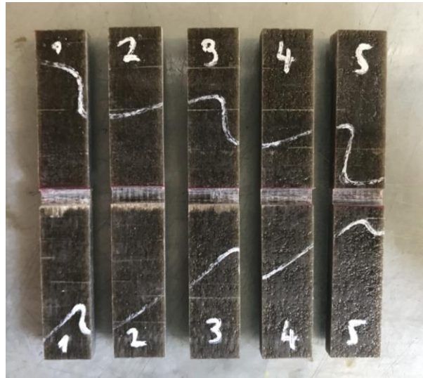
Figura 7-10. Probetas del ensayo de compresión a 0°
