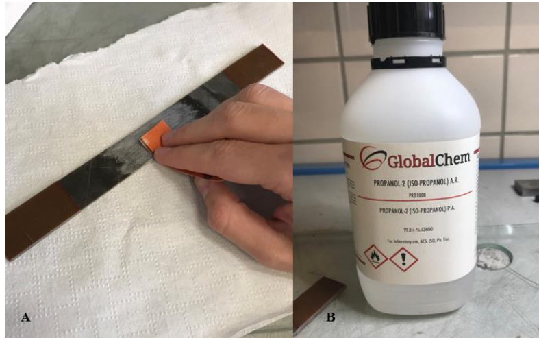
Figura 6-23. Preparación de la superficie de la probeta para pegar las bandas
