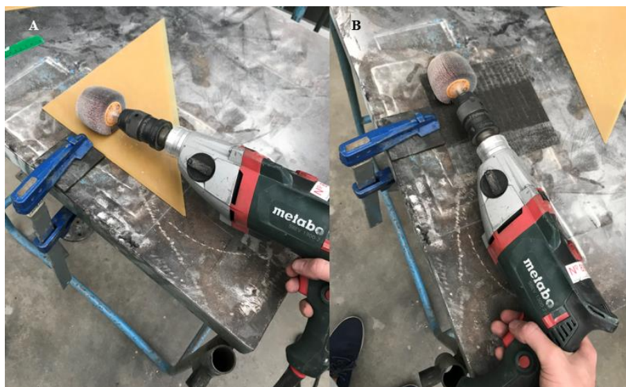
Figura 6-13. Lijado de tacones de fibra de vidrio y paneles de fibra de basalto
