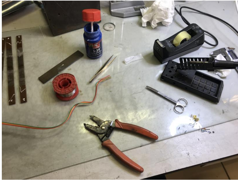
Figura 6-27. Instrumental para la adecuación de cables para la conexión con los terminales de las bandas
