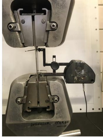
Figura 7-2. Extensómetro de 50 milímetros
