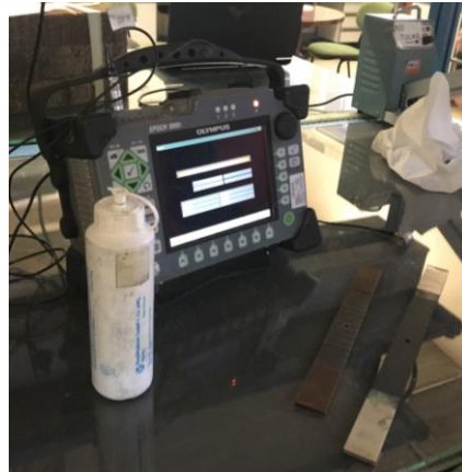
Figura 7-27. Equipo de ultrasonidos utilizado para examinar las probetas
