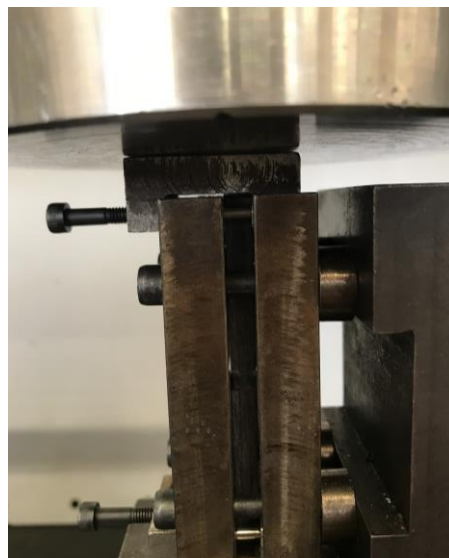
Figura 7-9. Preparación del ensayo de compresión poniendo en contacto el pistón de carga con el útil
