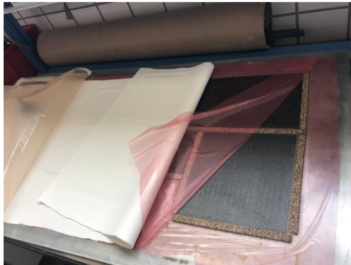
Figura 6-11. Bolsa de vacío después del curado en autoclave
