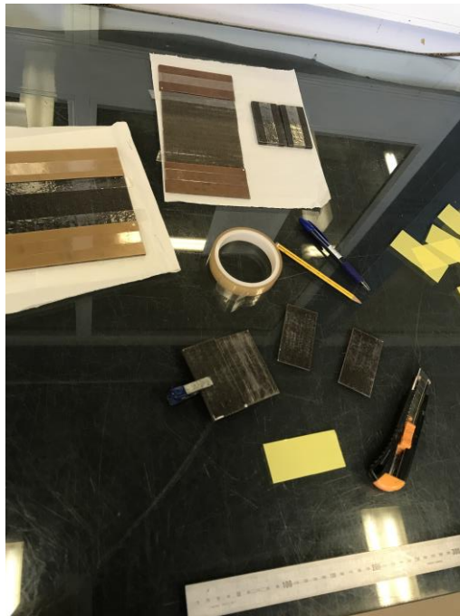
Figura 6-14. Colocación del adhesivo para pegar los tacones a los paneles
