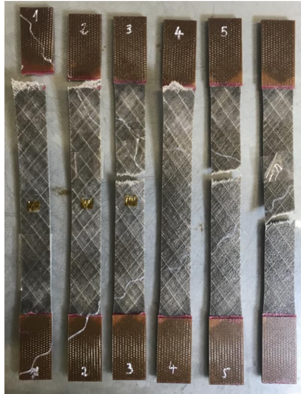
Figura 7-23. Modos de rotura de las probetas de cizalladura
