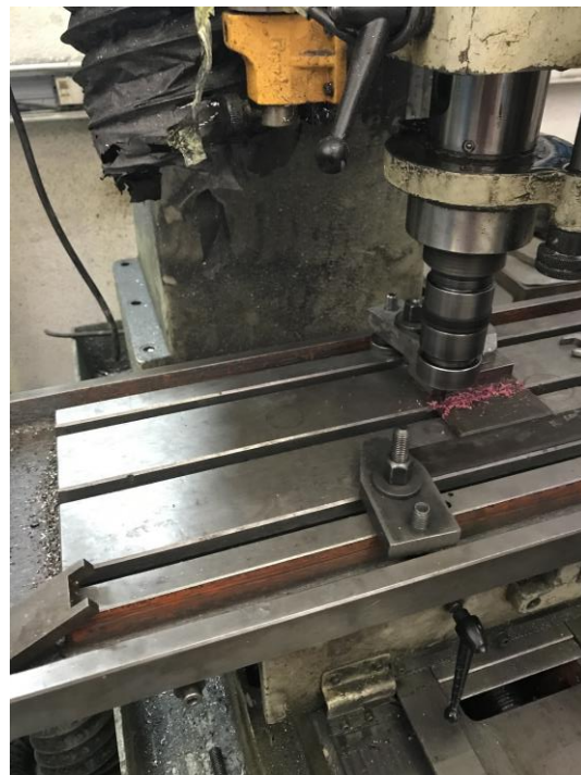
Figura 6-18. Resanamiento del centro de los paneles de compresión con la fresadora para retirar el adhesivo
