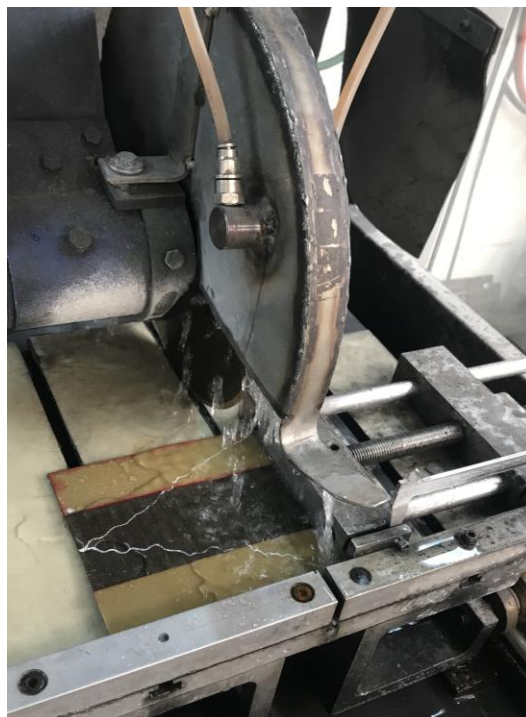
Figura 6-20. Corte de los paneles
