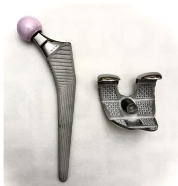
Figura 2-2. Recubrimientos de hidroxiapatita en prótesis articulares de cadera (izda) y rodilla (dcha)
