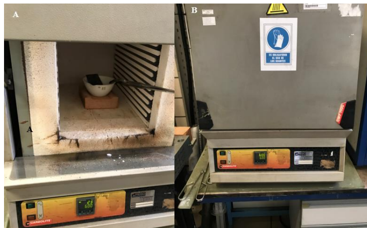
Figura A-11. Ensayo de calcinación
