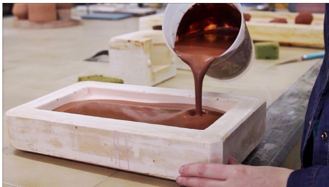
39. Vertimento da mistura em molde de gesso.
