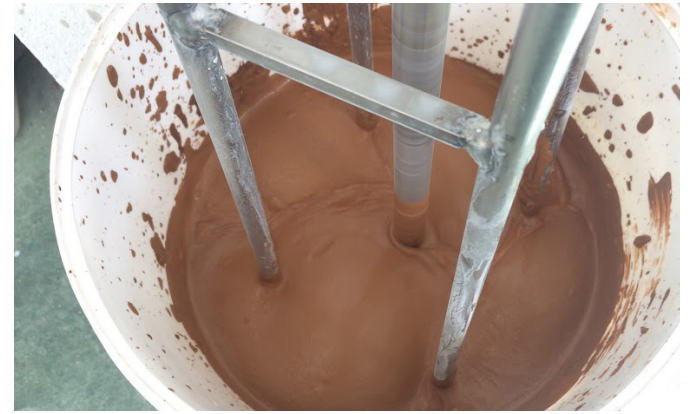
37. Uniformização da mistura com misturadora elétrica.
