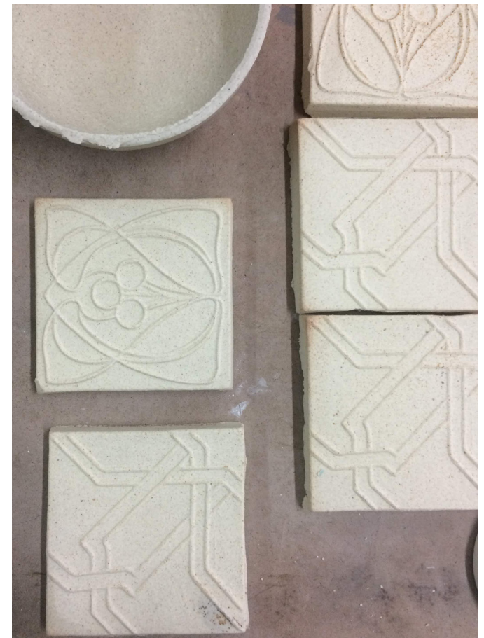
103. Peças cozidas a alta temperatura (1270°C).
