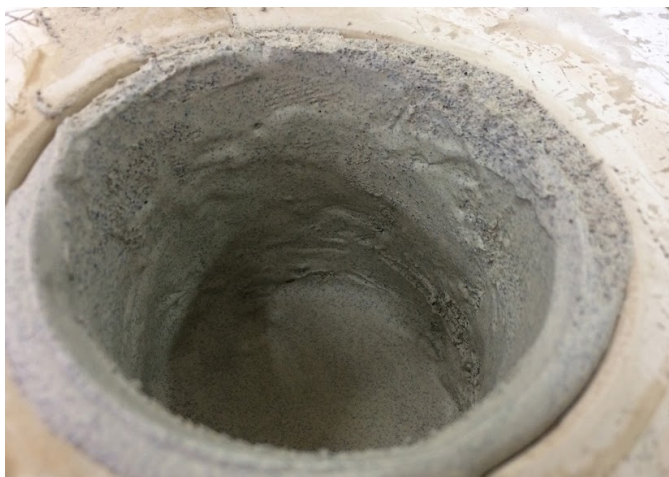
81. Peça por enchimento via líquida, porcelana com borras de café.
