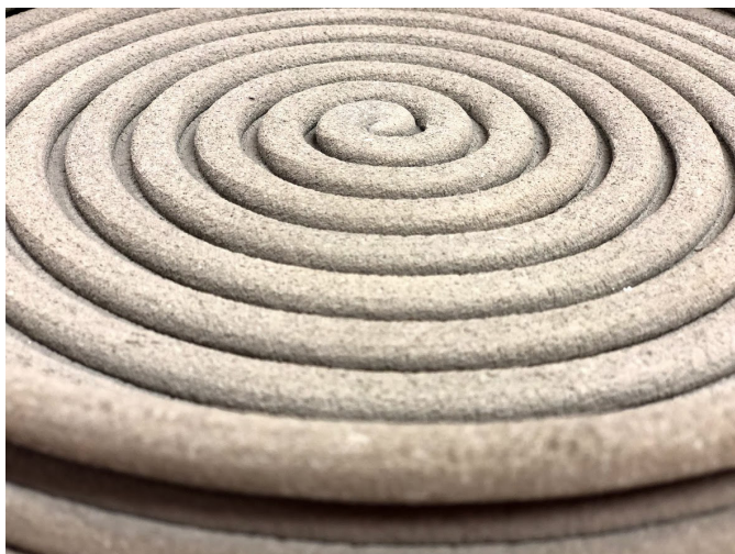
114. a 116. Peças teste. Faiença com borras de café. Robocasting 3D, CDRSP.
