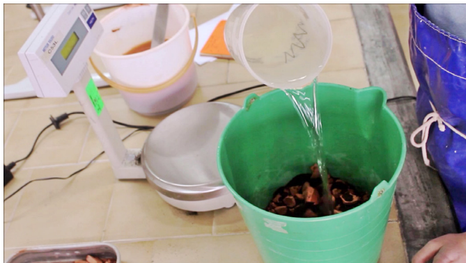
36. Colocação de água na mistura de argila com borras de café.
