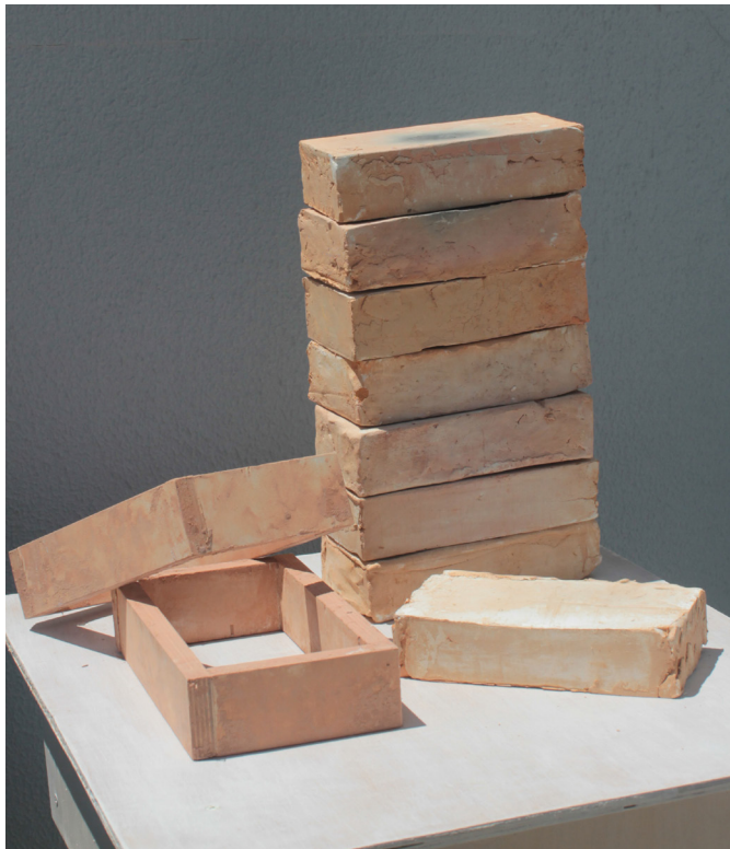
104. e 105. Peças feitas através de prensagem manual, usando um molde de madeira. Tijolos, barro vermelho e borras de café.
