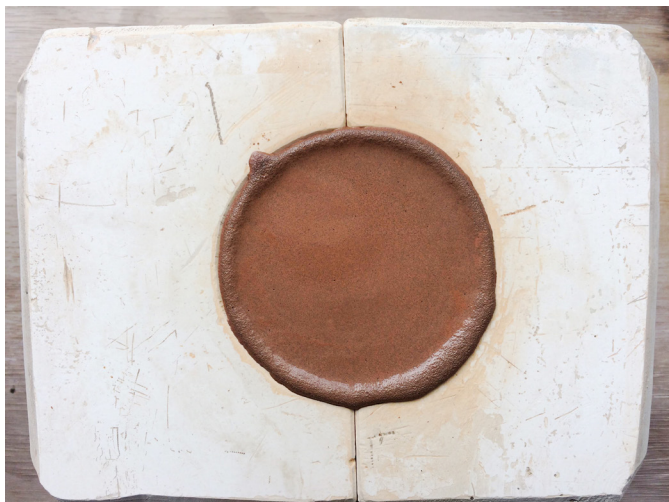
75. Barro vermelho com resíduos de café, formação de parede.
