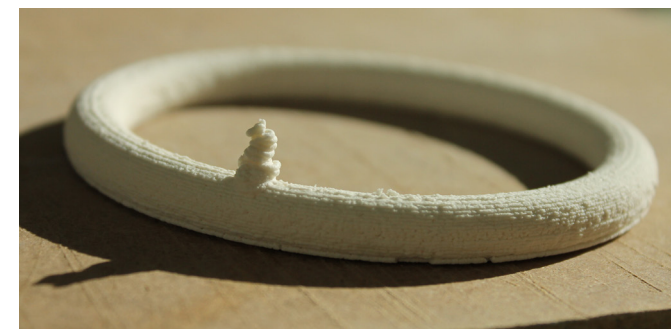
113. Primeiro teste construído através de fabricação aditiva. Porcelana com borras de café. Delta Wasp Clay, ESAD-CR.
