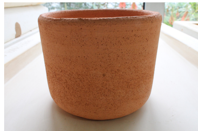
109. a 110. Peças teste realizadas por um estudante de olaria, no Cencal. Barro vermelho e faiança com borras de café. Peça crua e peça cozida.
