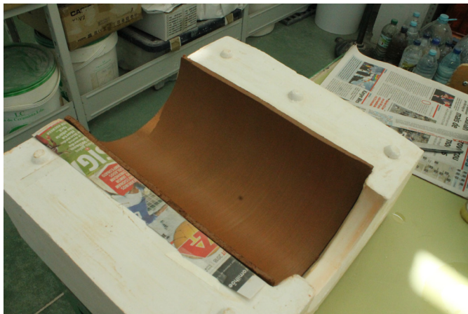
93. e 94. Barro vermelho com borras de café. Preparação das lastras.
