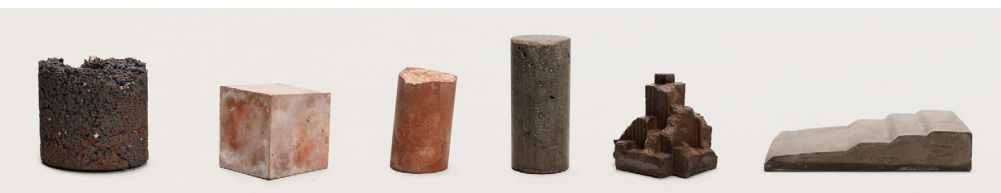
20. Amostras de geopolímero feitas com lama vermelha vitrificada.
