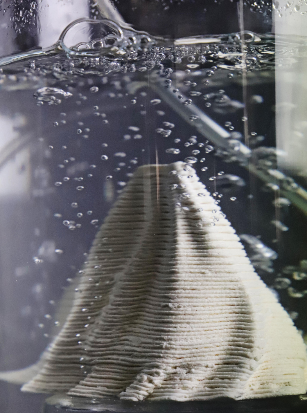
136. Protótipo filtro arejador de ar ligado a bomba de ar. Modelo Alga 2.
