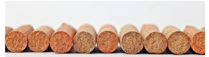
56. Provetes de barro vermelho com 15% de resíduos de café.
