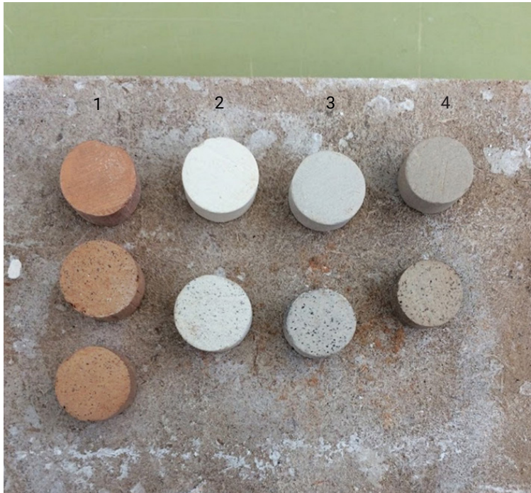
54. Fragmentos de provetes para teste, secos, não cozidos.
