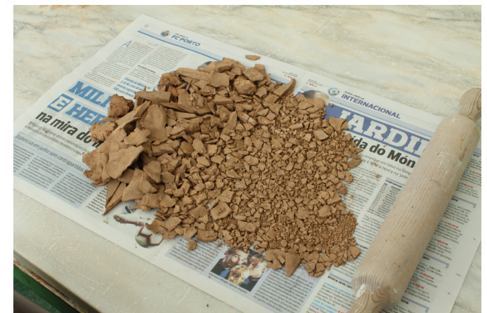
47. Pasta seca, pronta para ser moída com o rolo de madeira. Barro vermelho com 15% borras de café.
