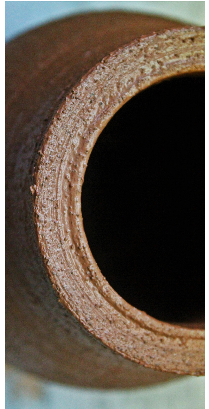
45. Textura da pasta ainda crua. Barro vermelho com 15% de borras de café. Peça modelada através de olaria.
