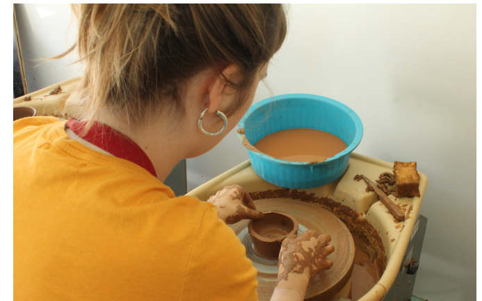
106. Técnica de roda de oleiro. Barro vermelho com borras.
