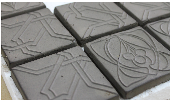
101. Peças realizadas através de prensa pneumática. Grês e borras de café.
