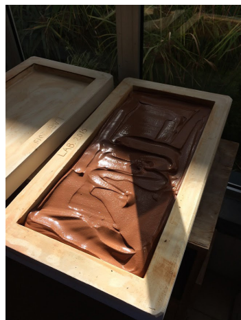
40. e 41. Secagem da pasta a temperatura ambiente.
