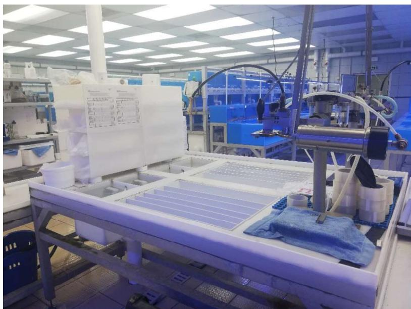
**Figura 2.11:** Mesa de embalagem. Local onde se colocam os peixes após a sua apanha e onde estes são embalados em sacos que são posteriormente fechados com grampos na máquina visível à direita.
