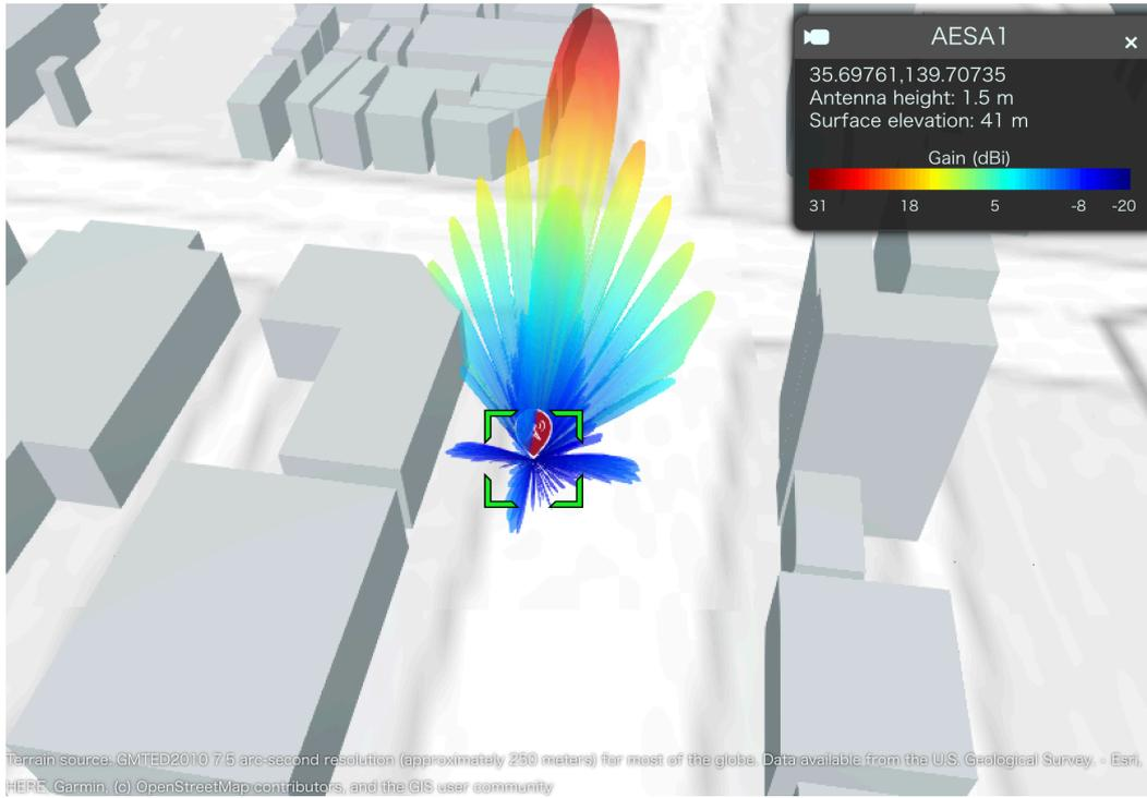
図 4.9 ETS-9 方向に設置した AESA アンテナの指向性
