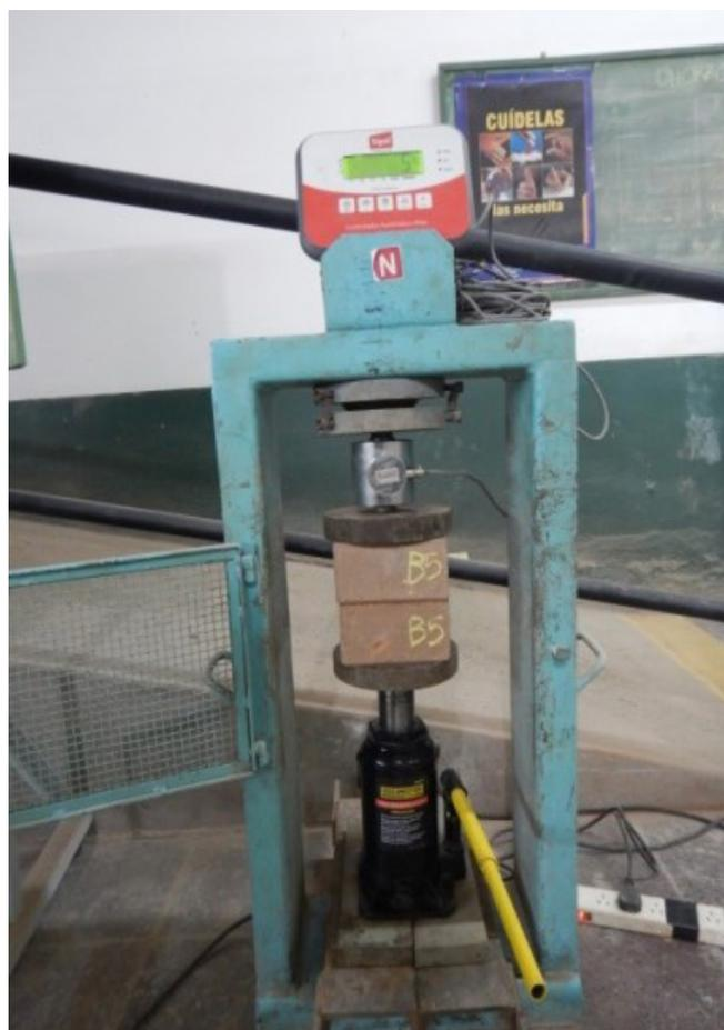
Figura 3. Equipo empleado para realizar los ensayos de compresión.
