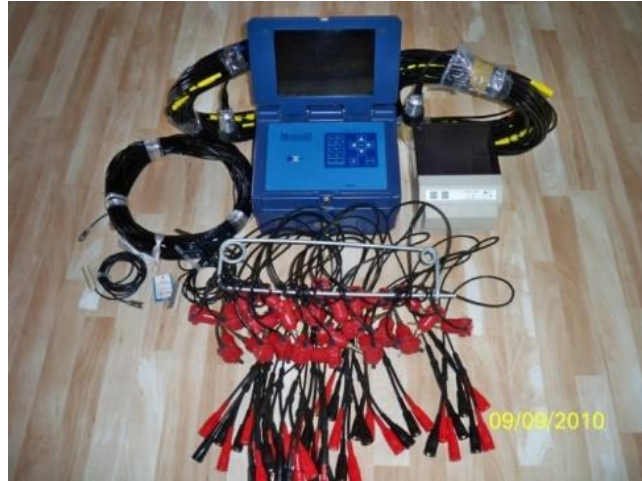
Şekil 7: Jeofizik çalışmada kullanılan sismik cihazın görünümü
