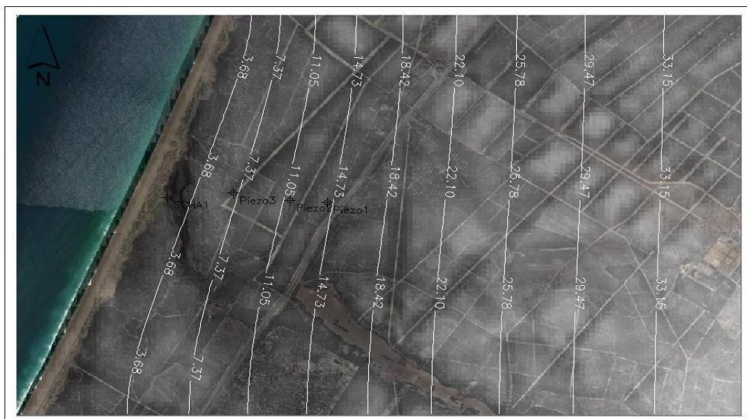
Figura 22 Piezometria do aquífero livre, superior, obtida por modelação numérica do fluxo subterrâneo.
