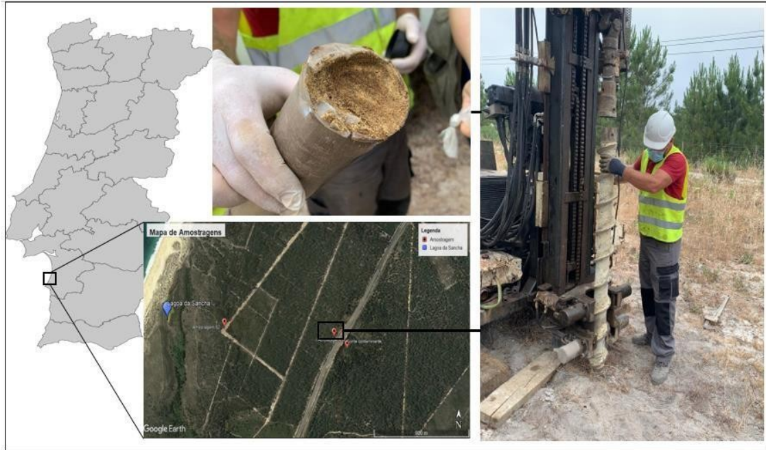
Figura 18 Localização das sondagens ambientais realizadas ao longo da pluma de contaminação; sondagem realizada a trado mecânico; amostrador com amostra indeformada.
