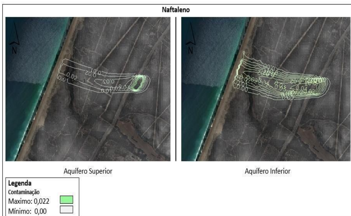
Figura 28 Isolinhas de concentração de naftaleno na água subterrânea, obtidas por modelação de transporte de massa com o software MT3DMS; concentração em mg/L.
