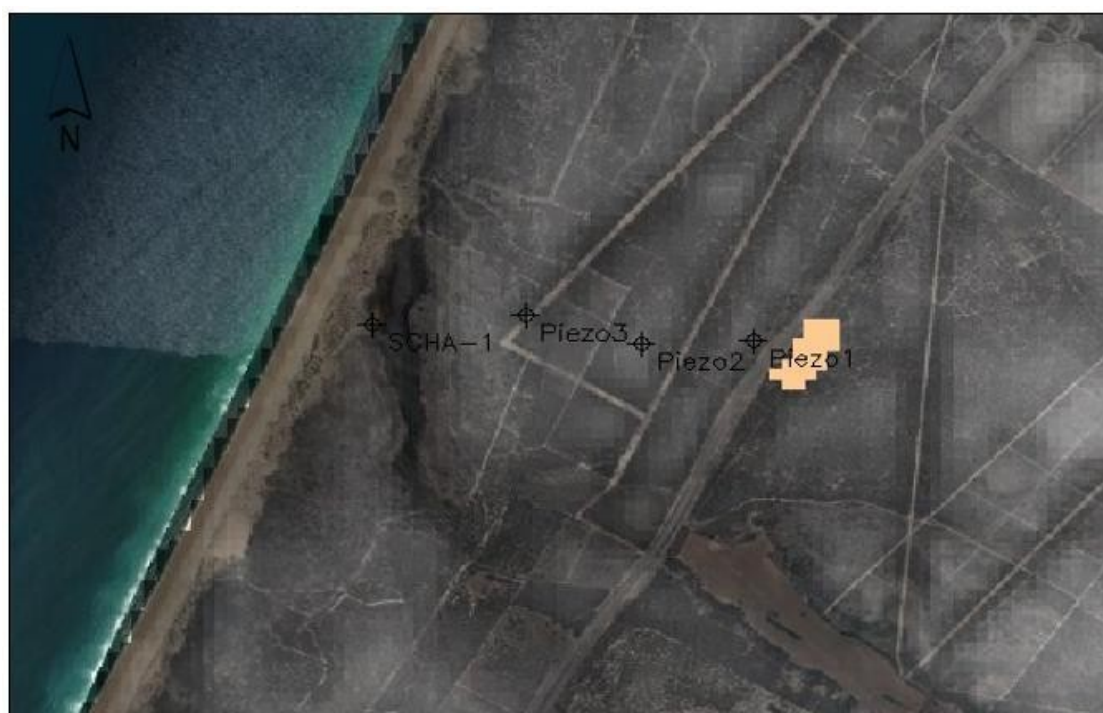
Figura 32 Proposta de localização de pontos de monitorização (piezómetros) da evolução da pluma de contaminação.
