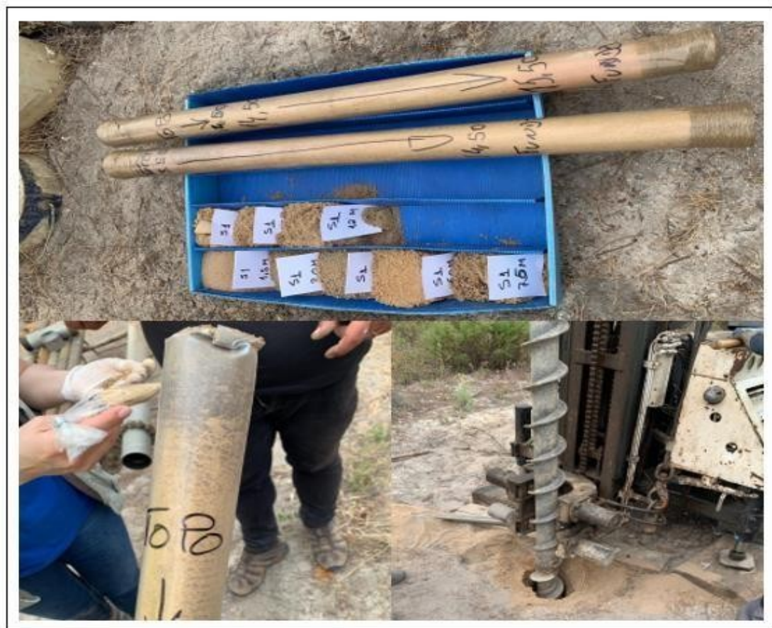
Figura 19 Amostras recolhidas durante a furação a trado oco (amostras remexidas) e amostrador com as amostras indeformadas recolhidas entre 13,5-14,5 m e 14,5-15,5 m de profundidade.
