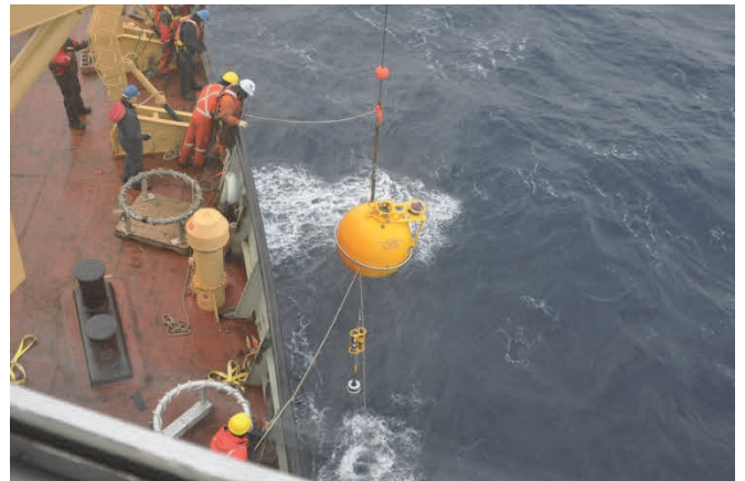
2012年8月LSSL号でのWHOI型係留系設置作業(写真: 館山一孝)
