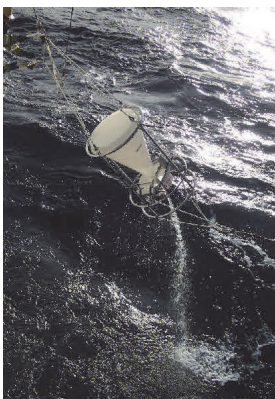
セジメントトラップの引き揚げ。（写真：菊地隆）
