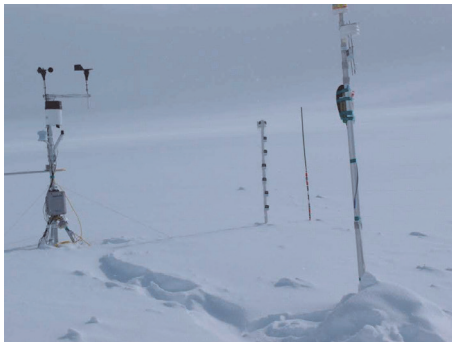
図 3.4.16 氷河上 (氷河キャンプ : 2446m.a.s.l.) に設置した自動気象測器 (AWS) ・温度計・インターバルカメラの写真 (白川作成)。
